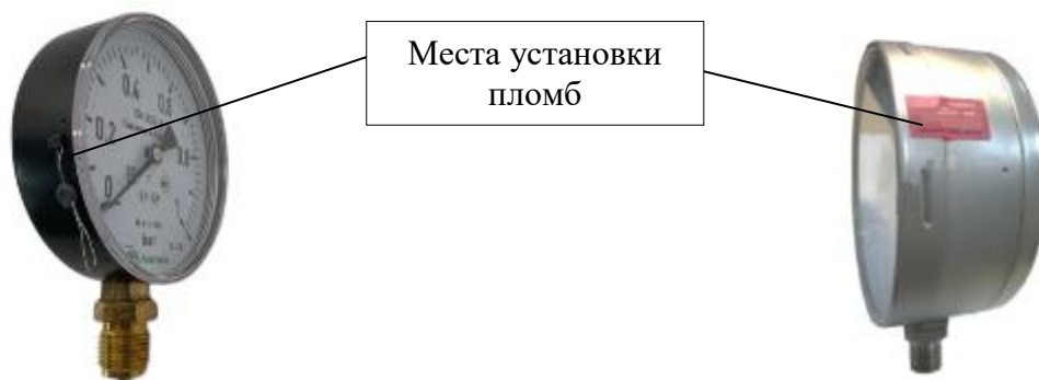
Рисунок 3 – Места пломбировки корпуса манометра
