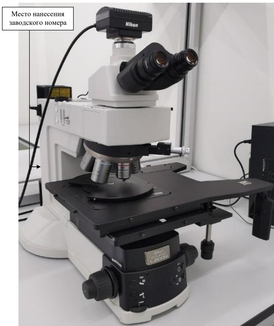
Рисунок 2 – Общий вид Микроскопа оптического инспекционного Eclipse L200ND
