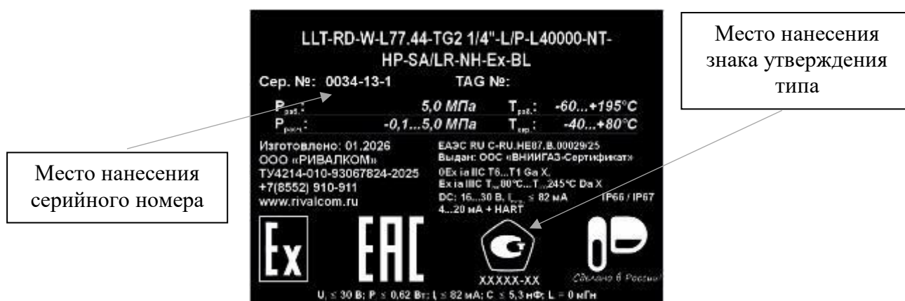
Рисунок 2 – Пример маркировочной наклейки с указанием места нанесения знака утверждения типа, места нанесения серийного номера
