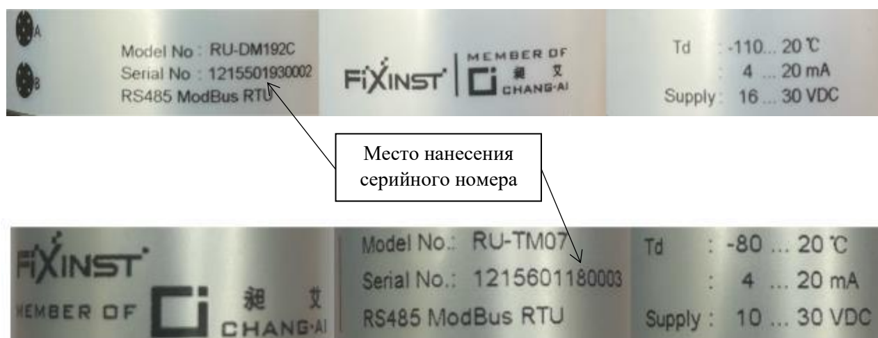
Рисунок 2 – Маркировочные таблички анализаторов точки росы RU модификаций RU-DM192C и RU-TM07
