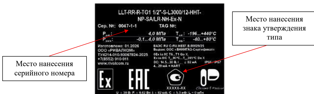
Рисунок 4 – Общий вид маркировочной наклейки уровнемеров с указанием места нанесения серийного номера и места нанесения знака утверждения типа
