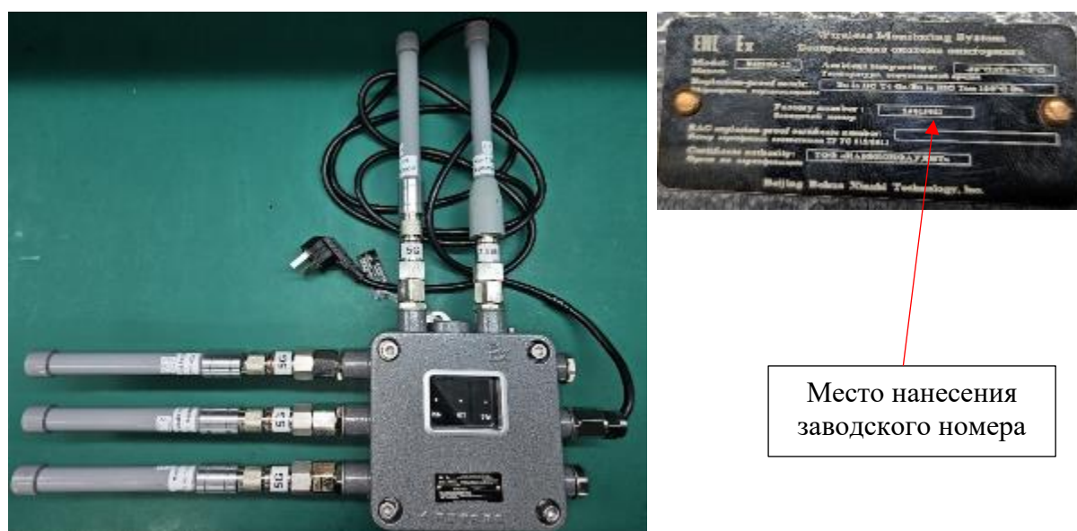
Рисунок 2 – Общий вид вспомогательного оборудования из состава систем мониторинга беспроводных BH306-12
