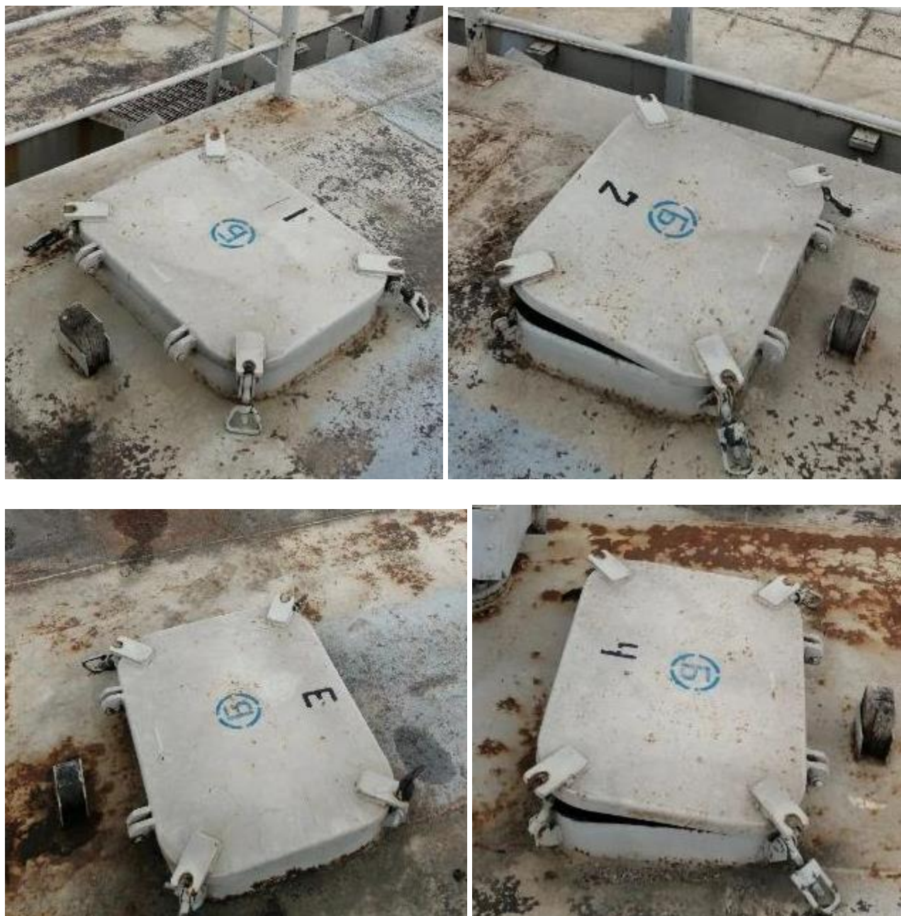
Рисунок 3 – Места нанесения заводских номеров
