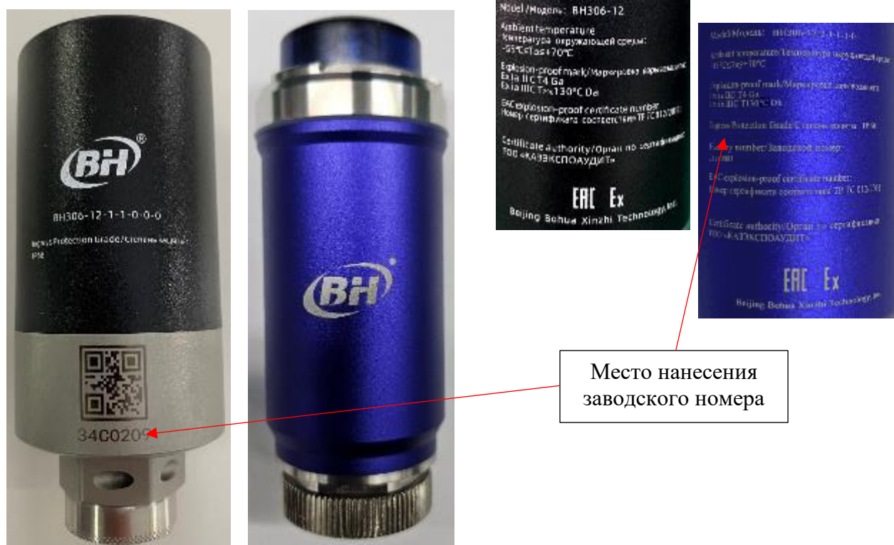
Рисунок 1 – Общий вид акселерометров из состава систем мониторинга беспроводных BH306-12
