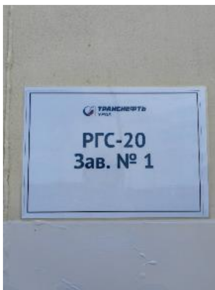
Рисунок 2 – Место нанесения заводского номера резервуара
