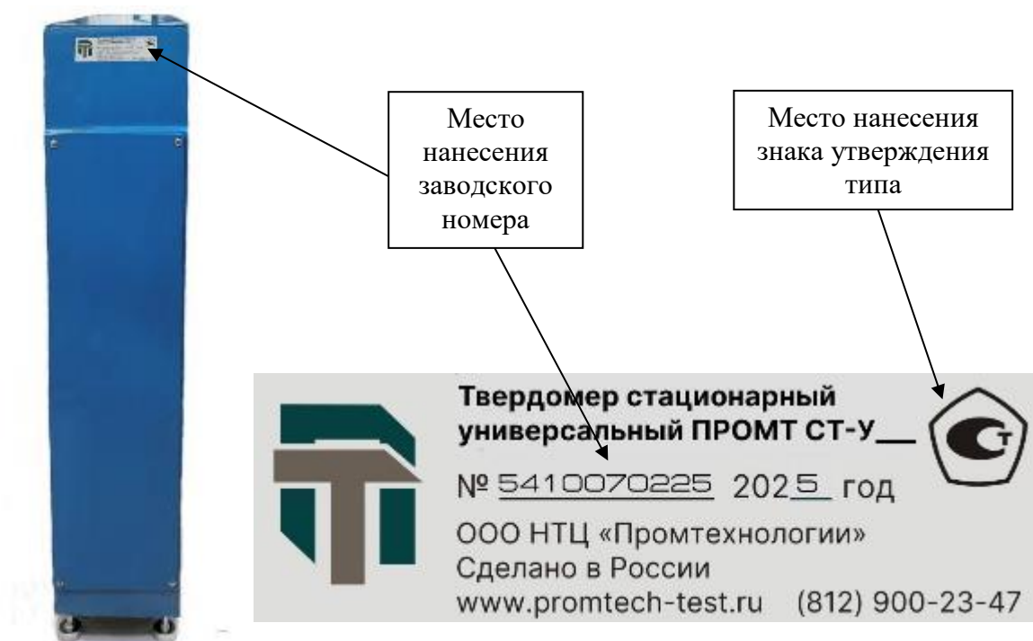
Рисунок 2 – Места нанесения заводского номера и знака утверждения типа
