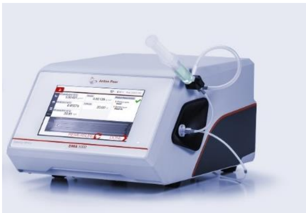
Рисунок 2 – Общий вид измерителей плотности модификаций DMA 1002, DMA 1002 Petro, DMA 1102 Petro
