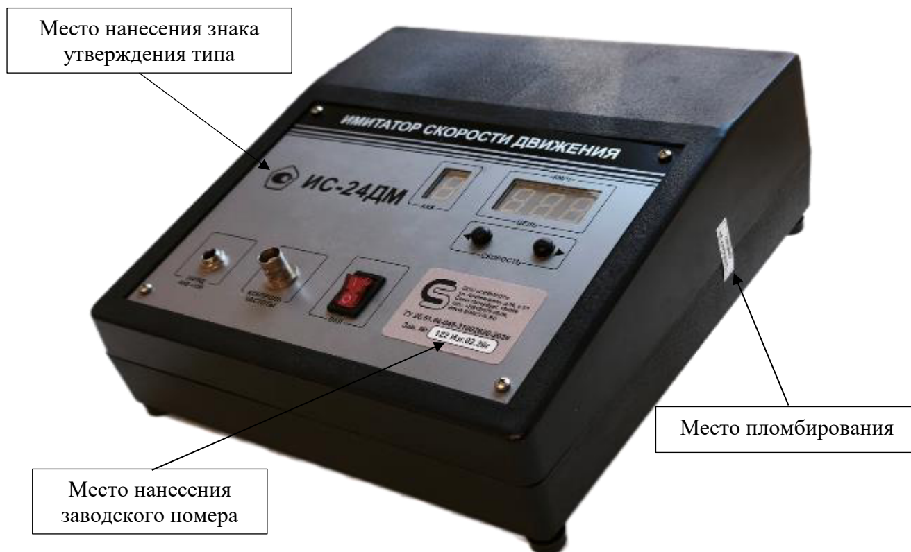
Рисунок 1 – Общий вид имитаторов, места пломбирования, нанесения знака утверждения типа и заводского номера
