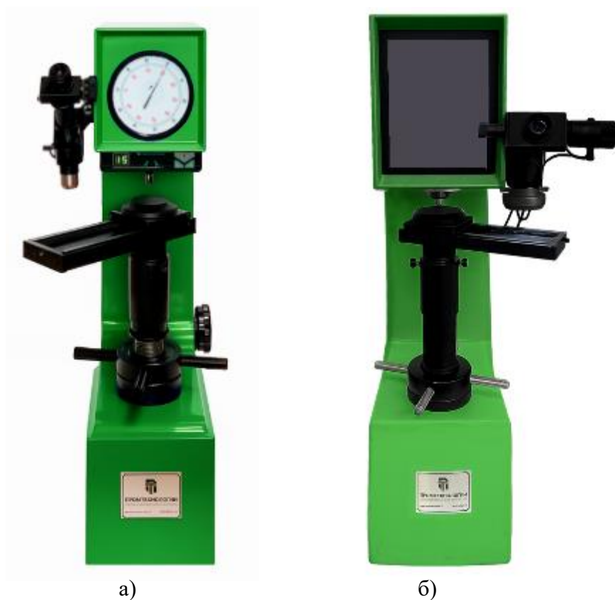
Рисунок 1 – Общий вид твердомеров а) Твердомеры стационарные универсальные ПРОМТ СТ-У б) Твердомеры стационарные универсальные ПРОМТ СТ-УЦ
