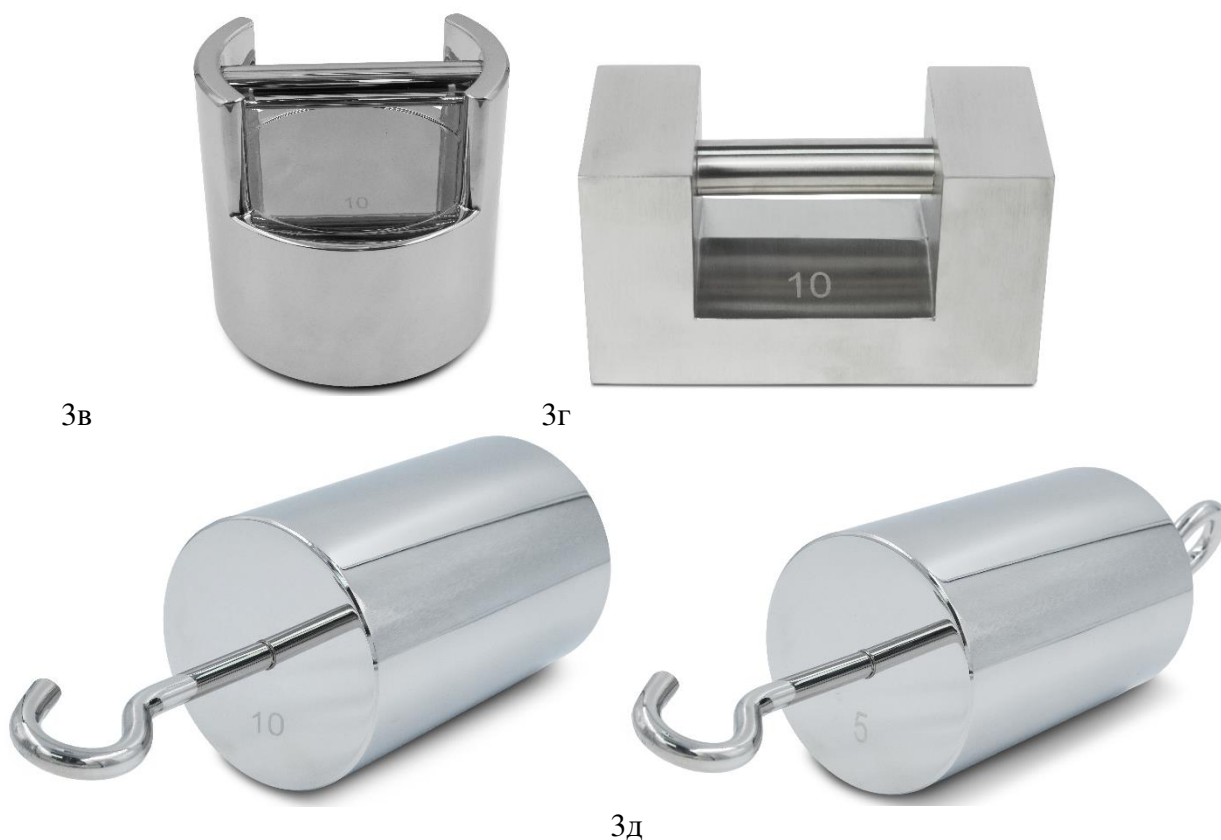
Рисунок 3 – Общий вид гирь из нержавеющей стали класса точности F_1 : (3а) – цилиндрической формы с головкой и без головки без подгоночной полости; (3б) – цилиндрической формы с головкой и без головки с подгоночной полостью; (3в) – в виде цилиндра с ручкой; (3г) – в виде прямоугольного параллелепипеда с ручкой, (3д) – в виде цилиндра с крюком и цилиндра с двумя крюками
