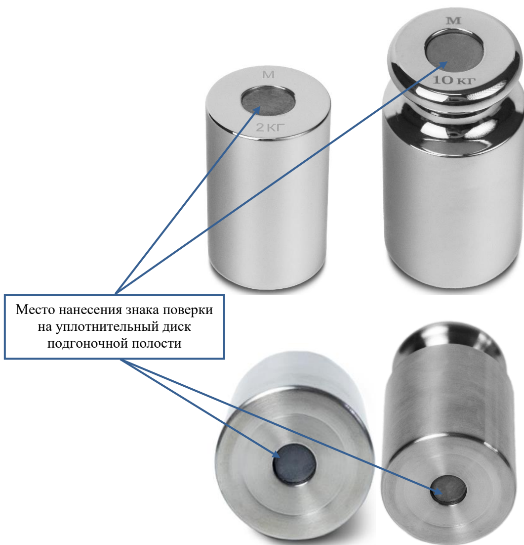
Место нанесения знака поверки на уплотнительный диск подгоночной полости 5а
