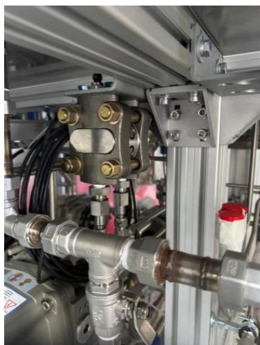
Рисунок 15 – Преобразователь разности давлений Корунд-ДД в месте установки
