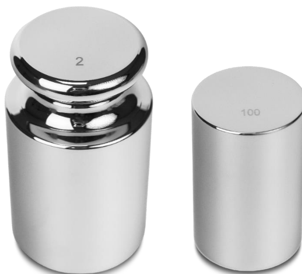
Рисунок 2 – Общий вид гирь из нержавеющей стали класса точности E_1 и E_2 цилиндрической формы с головкой и без головки без подгоночной полости
