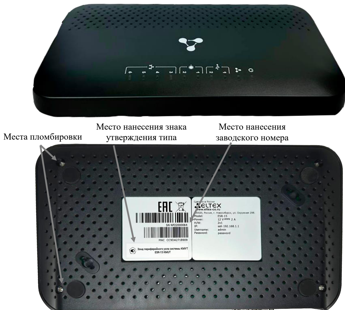
Рисунок 3 – Внешний вид зондов ESR модификаций ESR-15 KMUT
