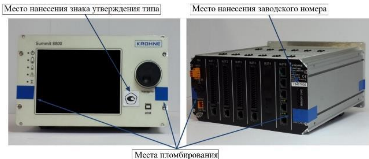
Рисунок 1 – Общий вид контроллеров с указанием мест нанесения знака утверждения типа, заводского номера и места пломбирования
