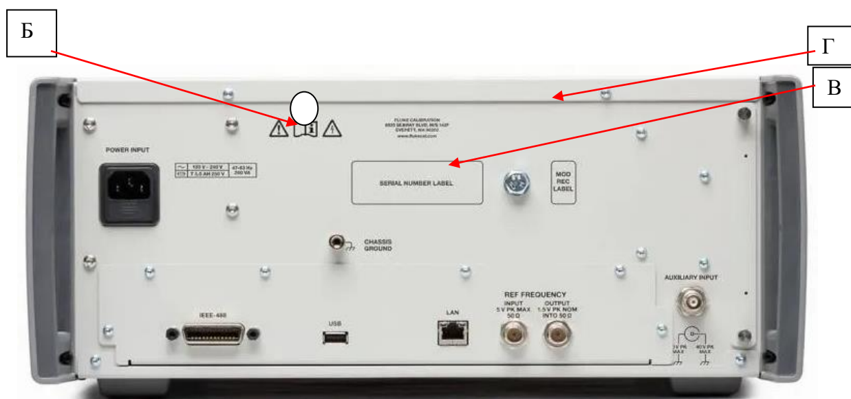
Рисунок 2 – Вид задней панели калибратора, схема пломбировки от несанкционированного доступа (Б), место нанесения серийного номера (В) и знака поверки (Г)
