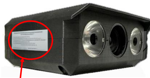
Место нанесения маркировки с заводским номером и знаком утверждения типа
