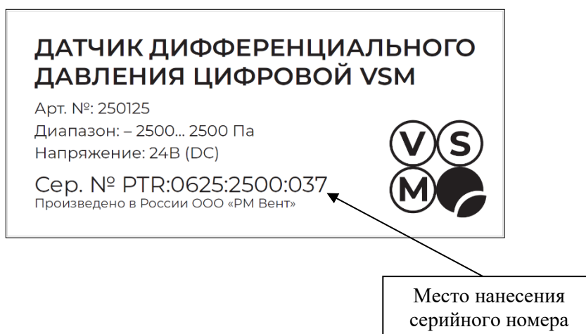
Рисунок 2 - Общий вид маркировочной таблички и место нанесения серийного номера
