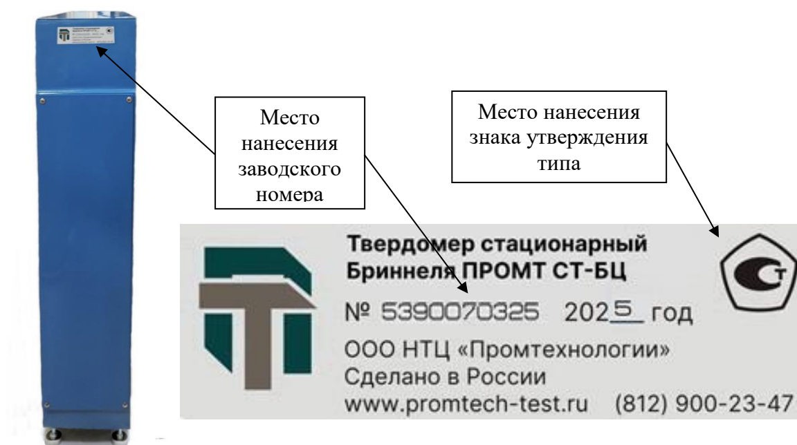
Рисунок 2 - Места нанесения заводского номера и знака утверждения типа
