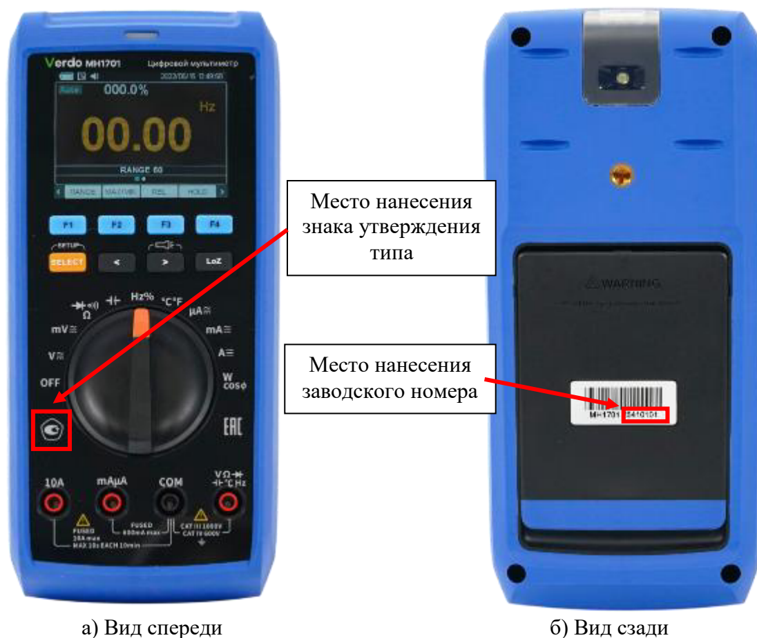
Рисунок 1 - Общий вид мультиметров с указанием места нанесения знака утверждения типа, места нанесения заводского номера
