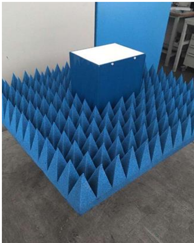
Рисунок 7 - Внешний вид эталонной антенны ТМА 6-40 Э
