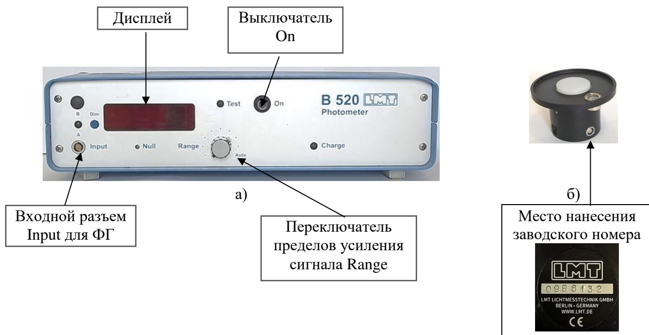
а) - передняя панель измерительной консоли; б) - фотометрическая головка
