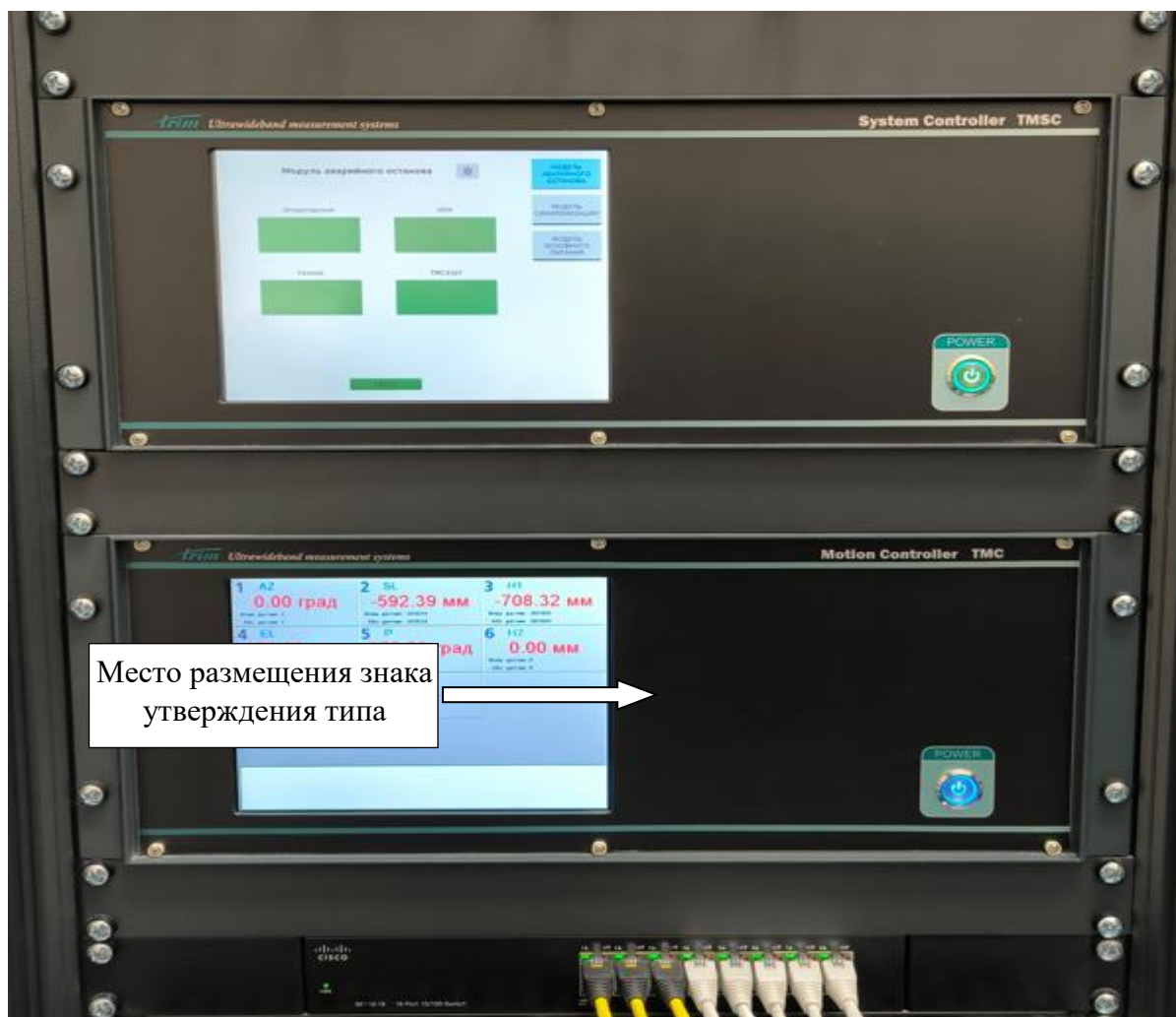
Рисунок 5 - Внешний вид передних панелей системного контроллера TMSC и контроллера перемещения TMC 3134 с указанием места размещения знака утверждения типа
