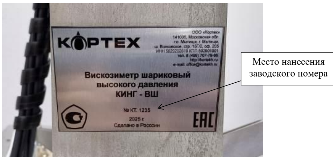
Рисунок 2 – Место нанесения заводского номера на вискозиметры шариковые высокого давления КИНГ-ВШ
