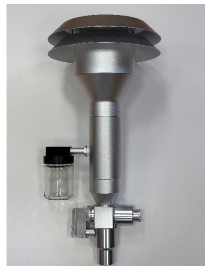
Импактор с циклоном для измерений массовой концентрации пыли по фракции PM2.5
