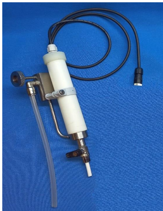
Датчик растворенного кислорода, используемый в исполнениях ДКНБ. 414310.001, -01, -03, -04
