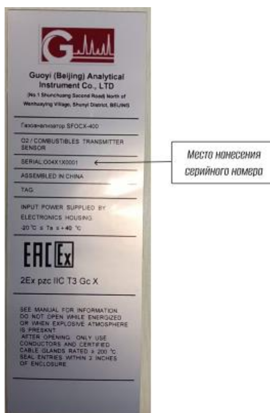
Рисунок 2 – Идентификационная табличка с указанием места нанесения серийного номера
