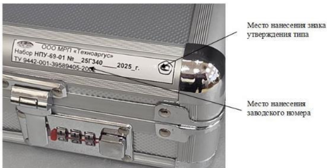
Рисунок 2 – Место нанесения заводского номера и знака утверждения типа
