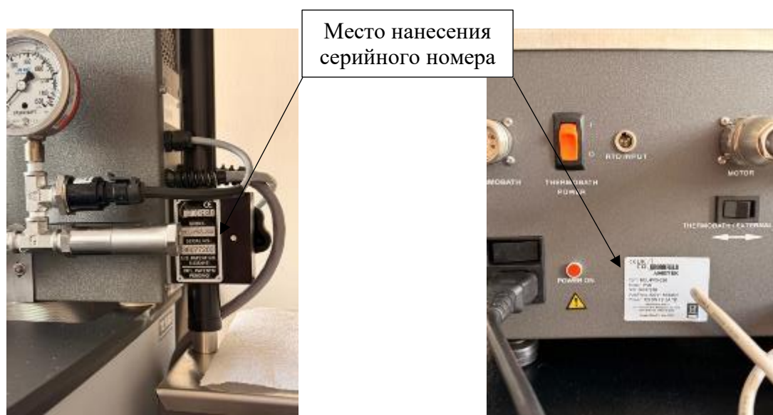
Рисунок 2 – Место нанесения серийного номера на реометры Брукфильда PVS-230
