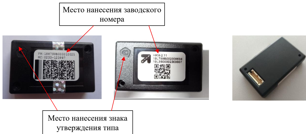
Рисунок 1 – Общий вид блоков, места нанесения знака утверждения типа и нанесения заводского номера
