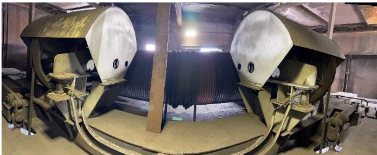
Рисунок 1 – Общий вид весов для взвешивания кокса ВВК
