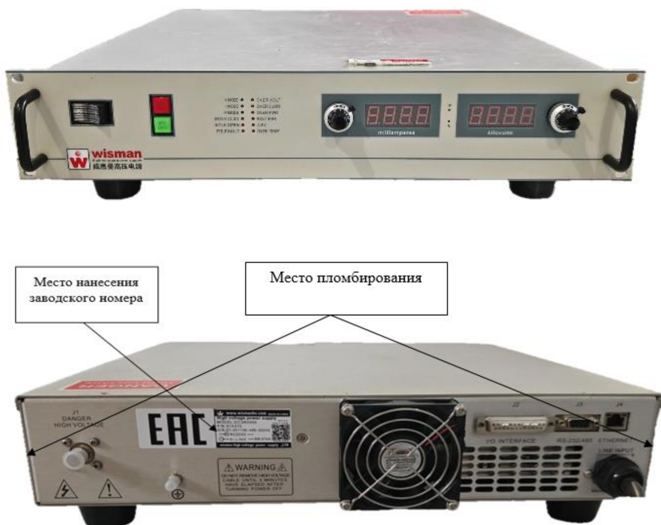
Рисунок 1 – Внешний вид источников питания модификации DC3R2000 с указанием места нанесения заводского номера и места пломбирования
