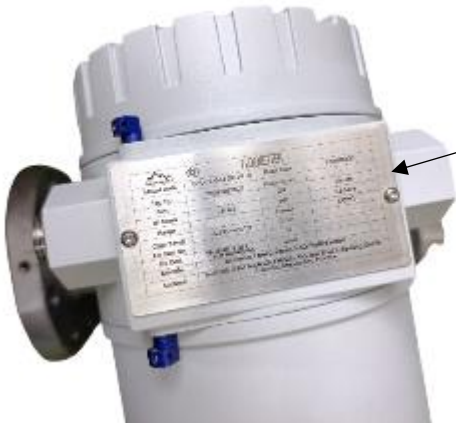
Рисунок 3 – Место крепления маркировочной таблички
