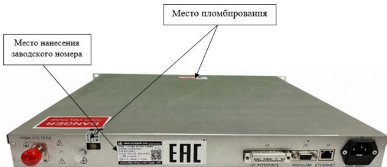
Рисунок 3 – Внешний вид источников питания модификаций DL60N300, DL60P300 с указанием места нанесения заводского номера и места пломбирования
