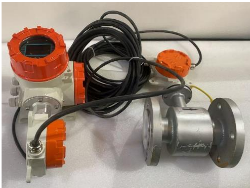
а) раздельное исполнение расходомеров
