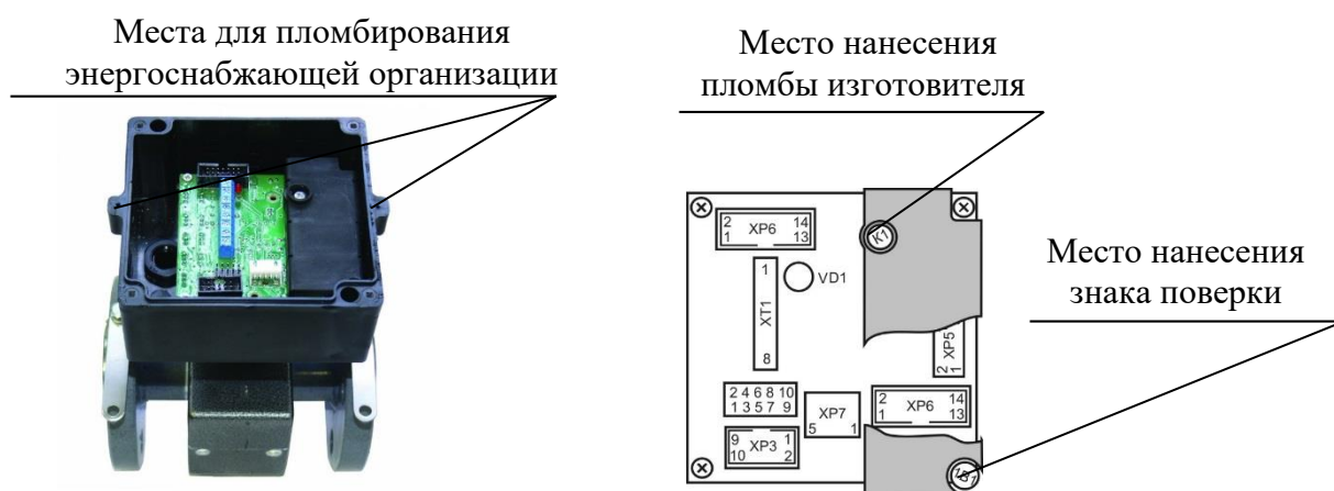
Рисунок 2 – Схема пломбировки от несанкционированного доступа, обозначение места нанесения знака поверки
