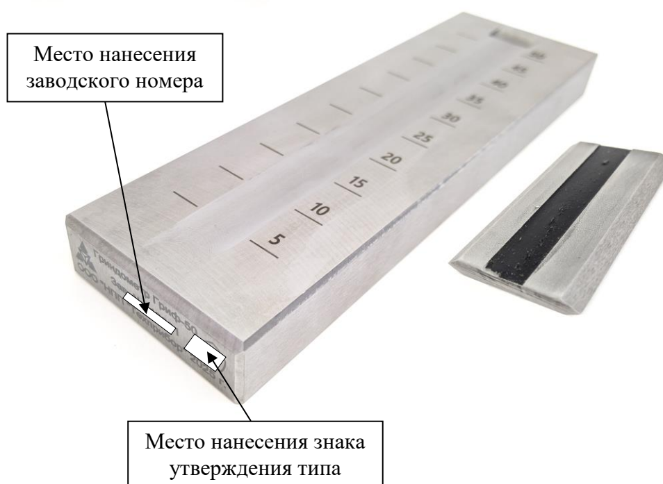
Рисунок 1 – Общий вид гриндометров с указанием мест нанесения заводского номера и знака утверждения типа
