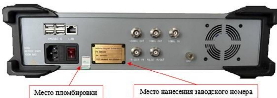
Рисунок 2 – Задняя панель корпуса генераторов сигналов InfosteraLuna MSG
