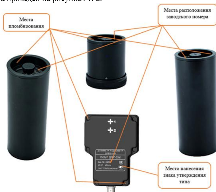
Рисунок 1 – Вид мест пломбирования, нанесения знака утверждения типа, заводского номера
