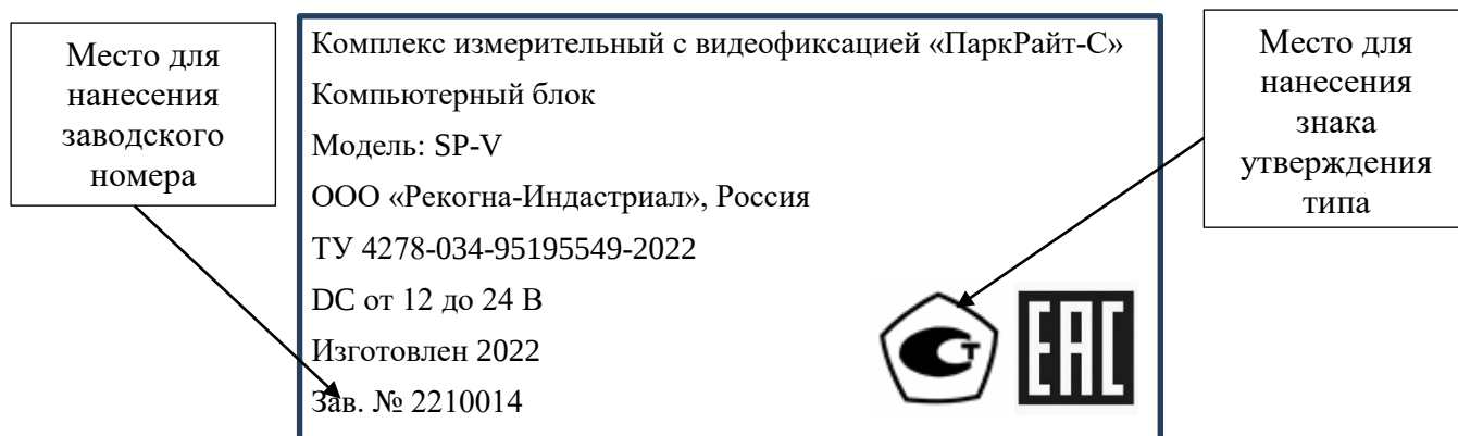
Рисунок 9 – Пример маркировки составной части комплексов и обозначение места для нанесения знака утверждения типа и заводского номера
