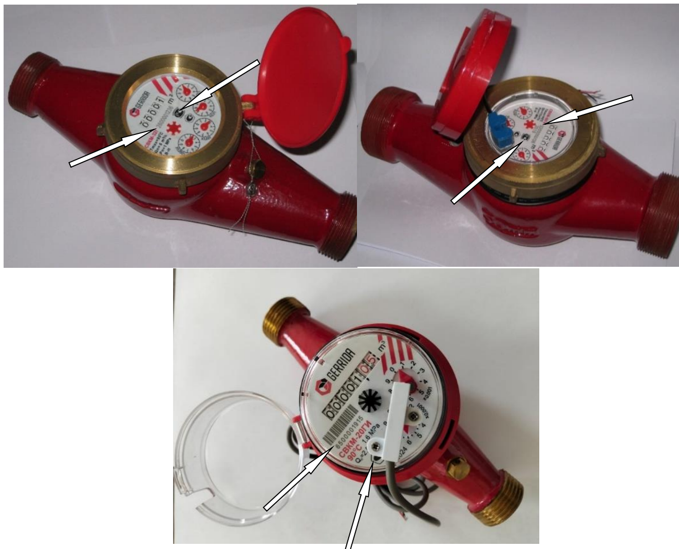
Рисунок 5 – Схема нанесения знака утверждения типа и заводского номера счетчиков воды крыльчатых СВКМ
