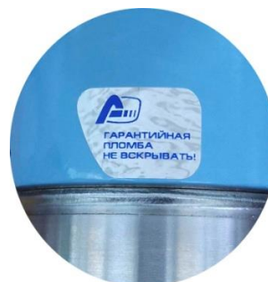
Рисунок 3 – пломба на стопорном винте (под табличкой), предотвращающем снятие корпуса электронного блока
