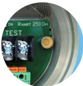
Рисунок 2 – внутренняя пломба на винте клеммной колодки
