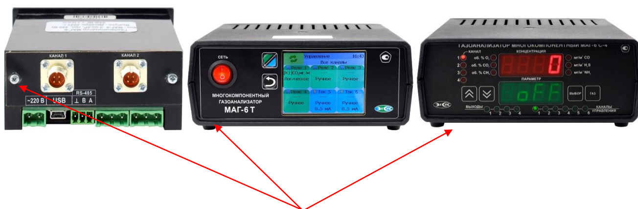
Рисунок 2б – Схема пломбирования от несанкционированного доступа (места пломбирования отмечены стрелками)
