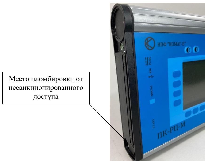
Рисунок 3 – Место пломбировки от несанкционированного доступа
