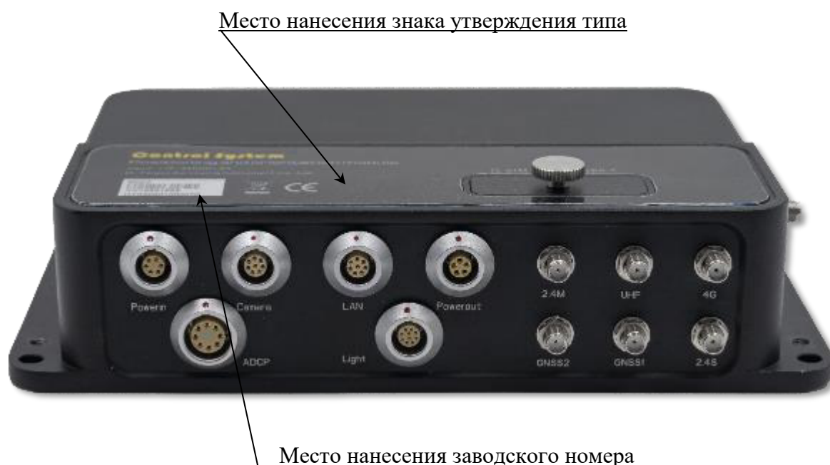
Рисунок 1 – Общий вид ГНСС-приемника из состава аппаратуры с указанием места нанесения знака утверждения типа и заводского номера
