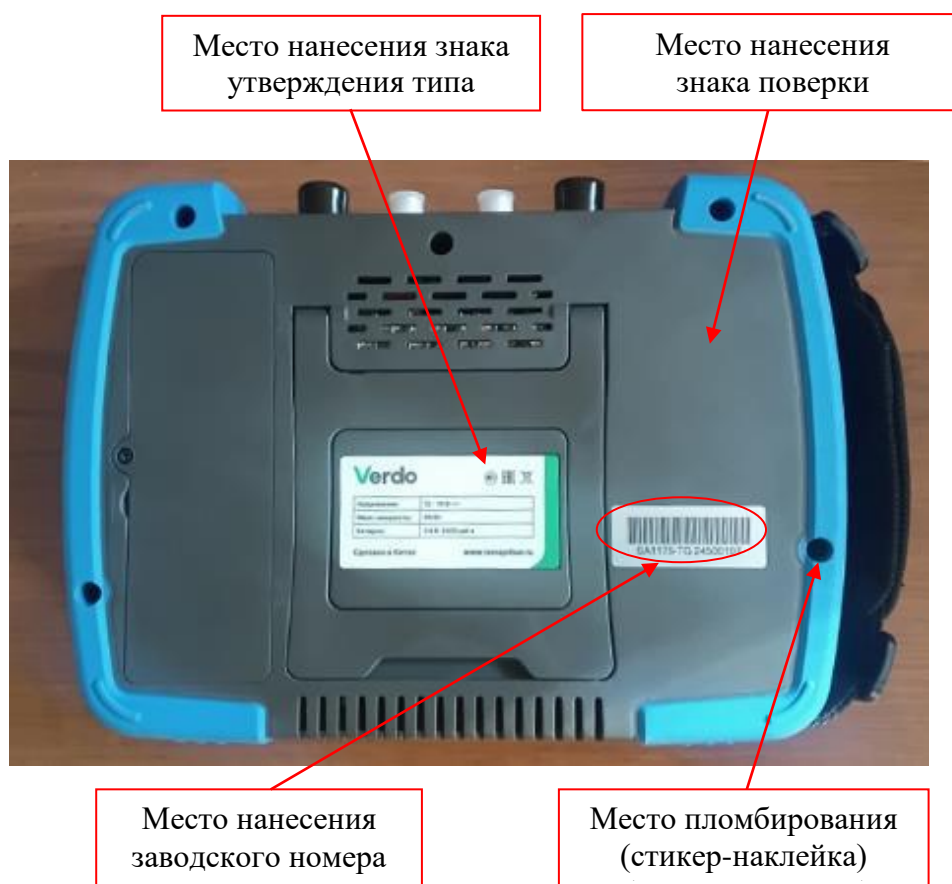
Рисунок 4 – Задняя панель анализаторов VERDO SA1ZZZ, модификации SA1116, SA1116-TG, SA1136, SA1136-TG, SA1175, SA1175-TG
