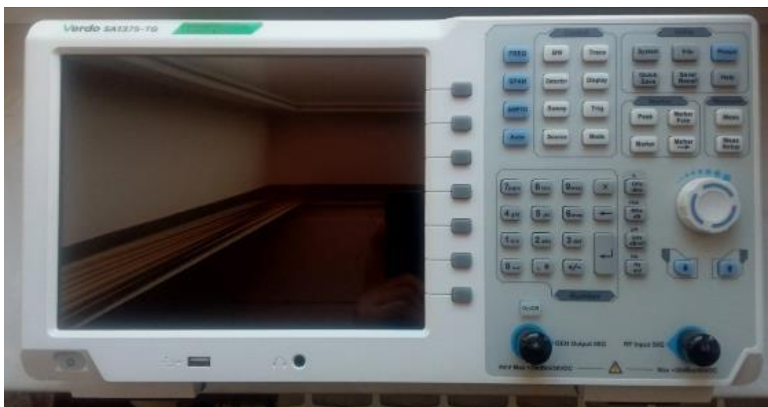
Рисунок 7 – Общий вид анализаторов VERDO SA1ZZZ, модификации SA1315, SA1315-TG, SA1336, SA1336-TG, SA1375, SA1375-TG
