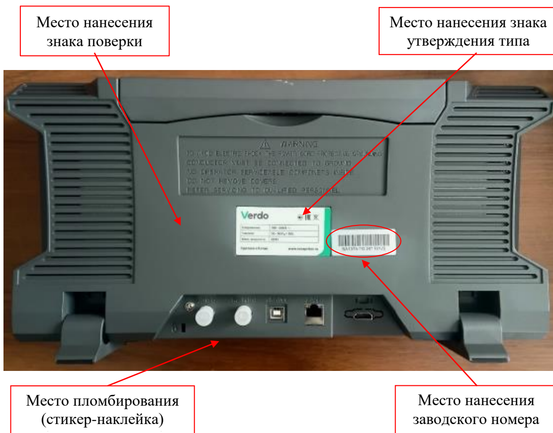
Рисунок 8 – Задняя панель анализаторов VERDO SA1ZZZ модификаций SA1315, SA1315-TG, SA1336, SA1336-TG, SA1375, SA1375-TG
