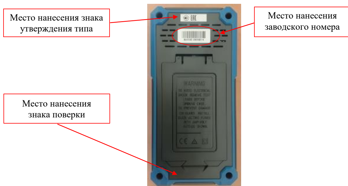
Рисунок 2 – Задняя панель анализаторов VERDO SA1ZZZ, модификации SA1037, SA1031, SA1032
