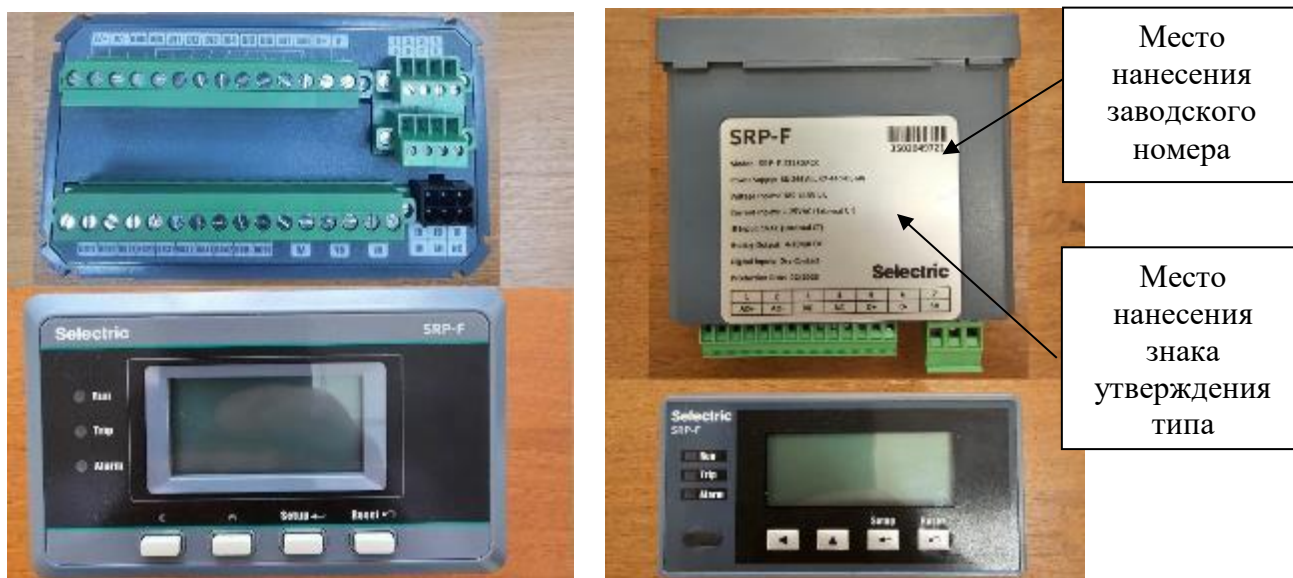
Рисунок 6 – Общий вид устройств модификации SRP-F с указанием места нанесения заводского номера и знака утверждения типа
