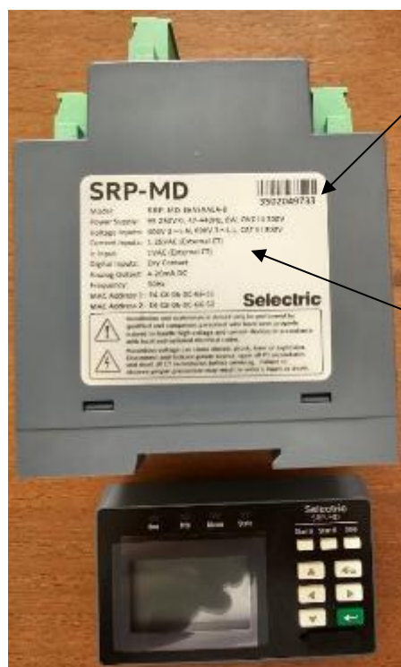
Рисунок 4 – Общий вид устройств модификации SRP-MD с указанием места нанесения заводского номера и знака утверждения типа
