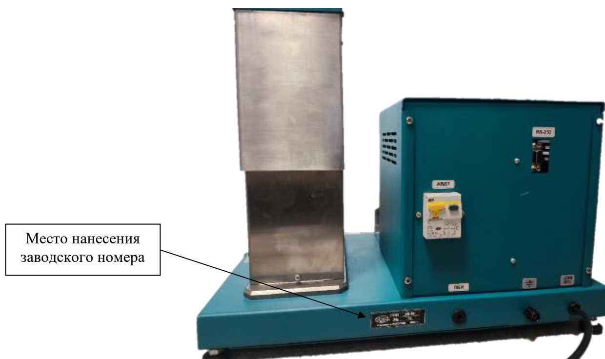
Рисунок 2 – Место нанесения заводского номера на Вискозиметры для определения динамической вязкости дорожных нефтяных битумов ЛинтеЛ® РВ-20
