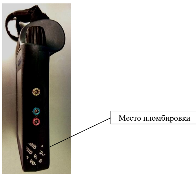
Рисунок 2 – Схема пломбировки от несанкционированного доступа
