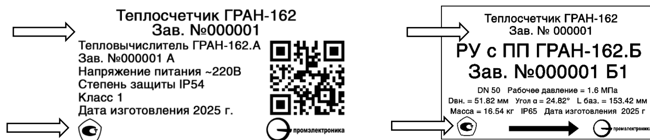
Рисунок 3 – Обозначения мест нанесения знака утверждения типа и заводского номера
