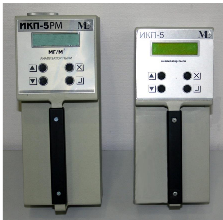
Рис. 1. Внешний вид анализаторов ИКП-5
