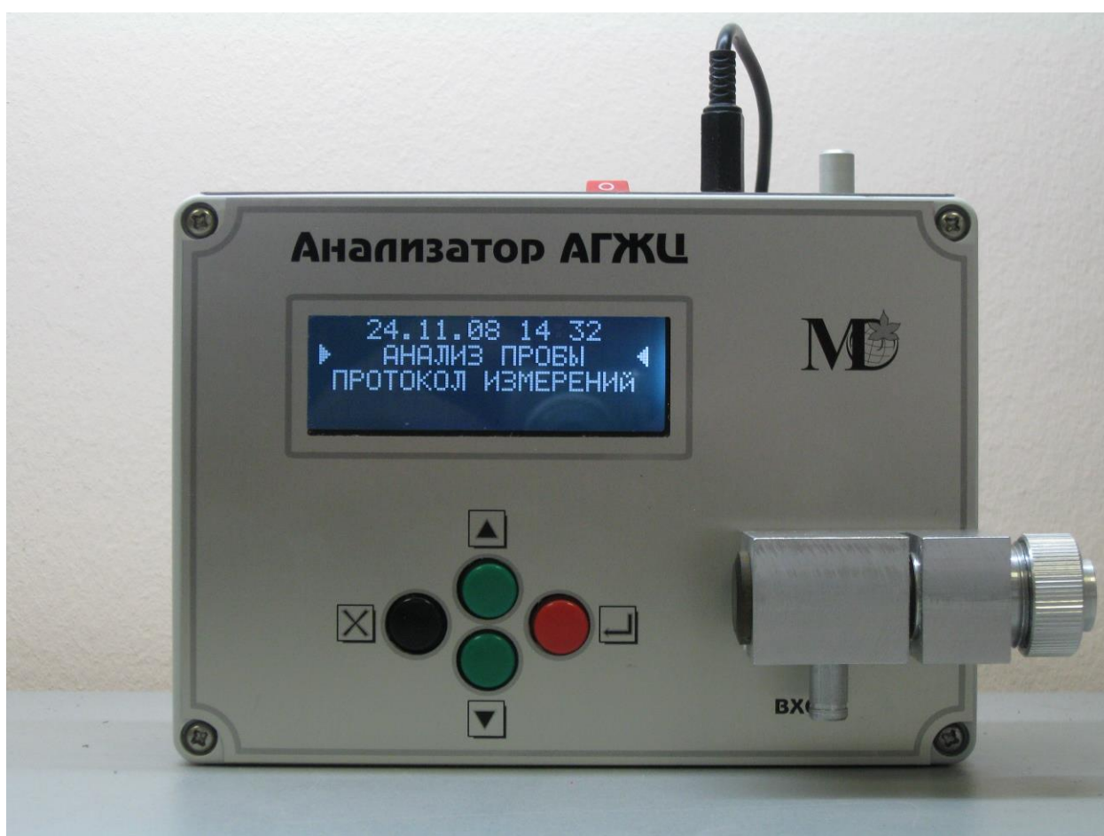
Рисунок 1 – Внешний вид анализатора газов и жидкостей АГЖЦ
