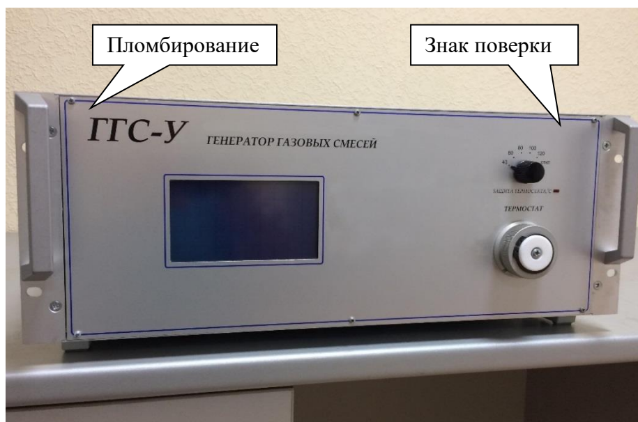
Рисунок 1 – Общий вид генераторов газовых смесей ГГС-У
