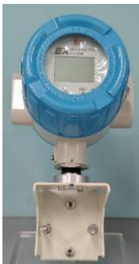
б) вторичный преобразователь раздельного исполнения расходомеров
