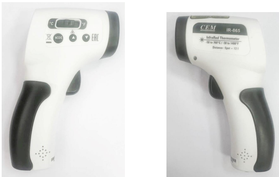
Рисунок 4 – Общий вид пирометров модели IR-865
