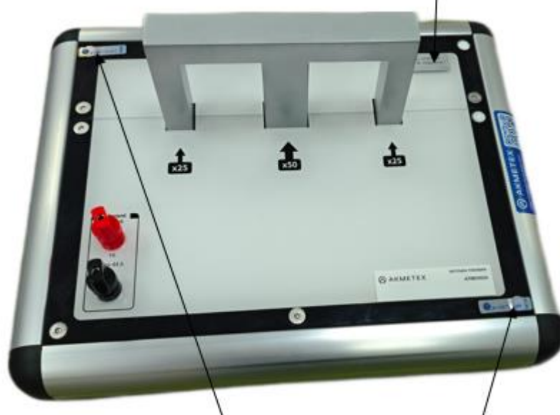
Рисунок 2 - Место нанесения заводского номера и места пломбирования от несанкционированного доступа катушек
