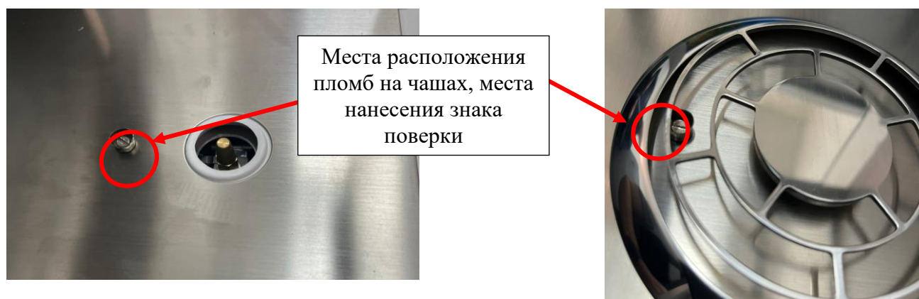
Рисунок 4 – Защита от несанкционированного доступа при внутренней юстировке
