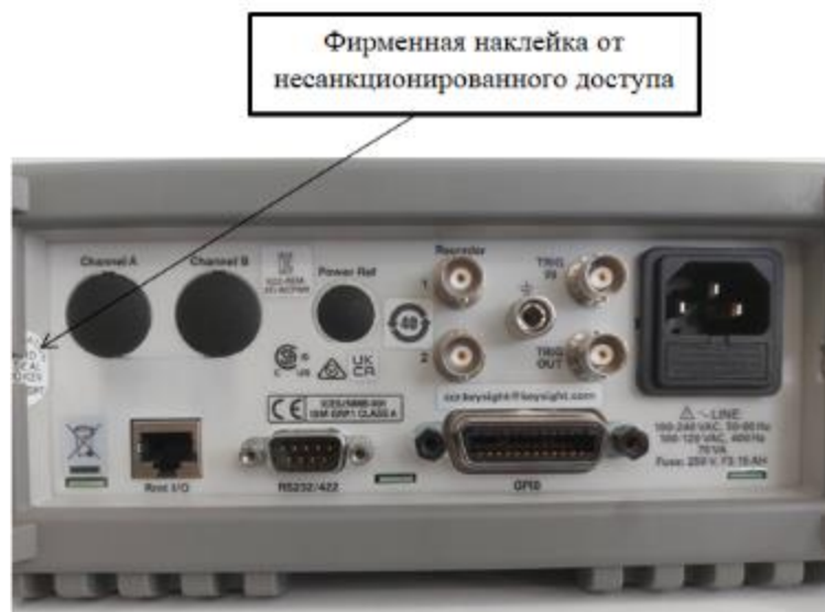
Рисунок 3 – Вид задней панели с указанием места пломбировки от несанкционированного доступа
