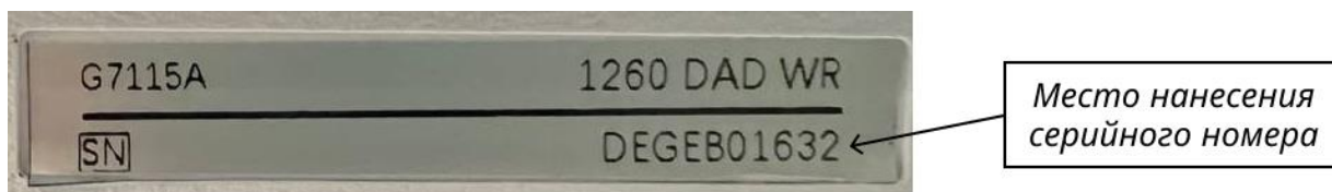
Рисунок 6 – Идентификационная табличка с указанием места нанесения серийного номера
