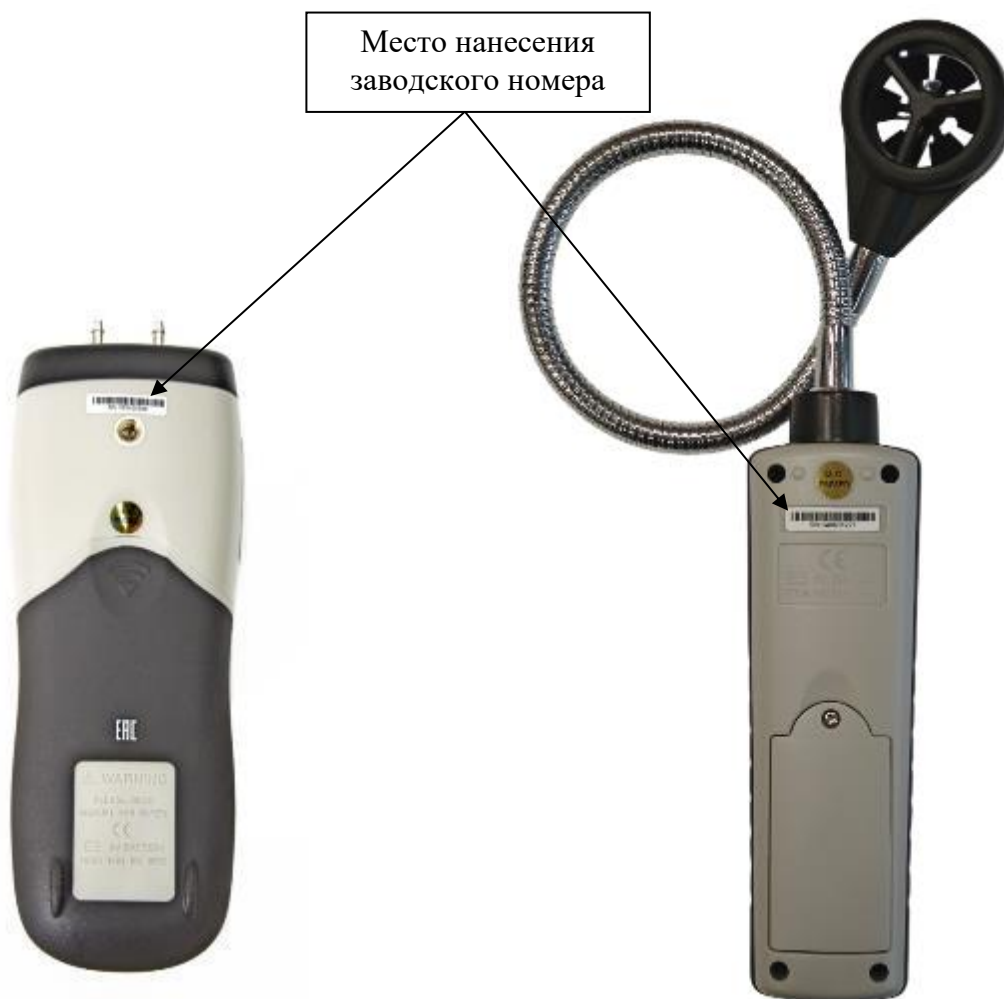
Рисунок 6 – Места нанесения заводского номера
