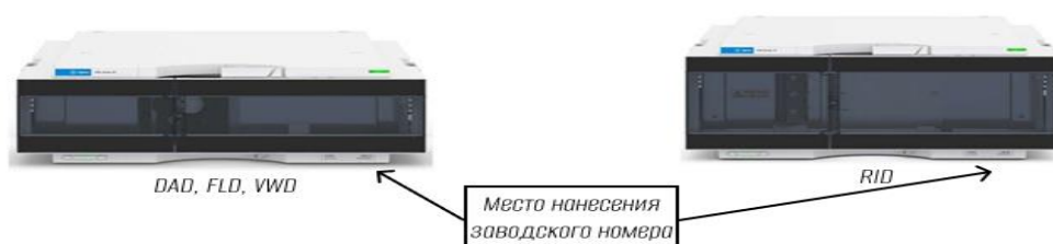
Рисунок 2 – Общий вид детекторов с указанием места нанесения заводского номера
