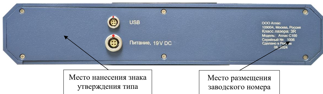
Рис. 2 – Место размещения заводского номера и нанесения знака утверждения типа
