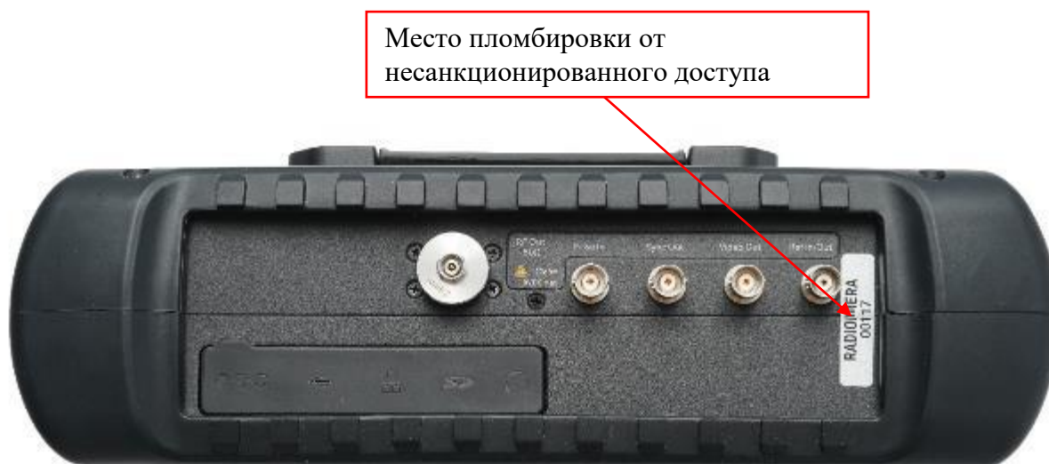
Рисунок 3 – Схема пломбировки от несанкционированного доступа
