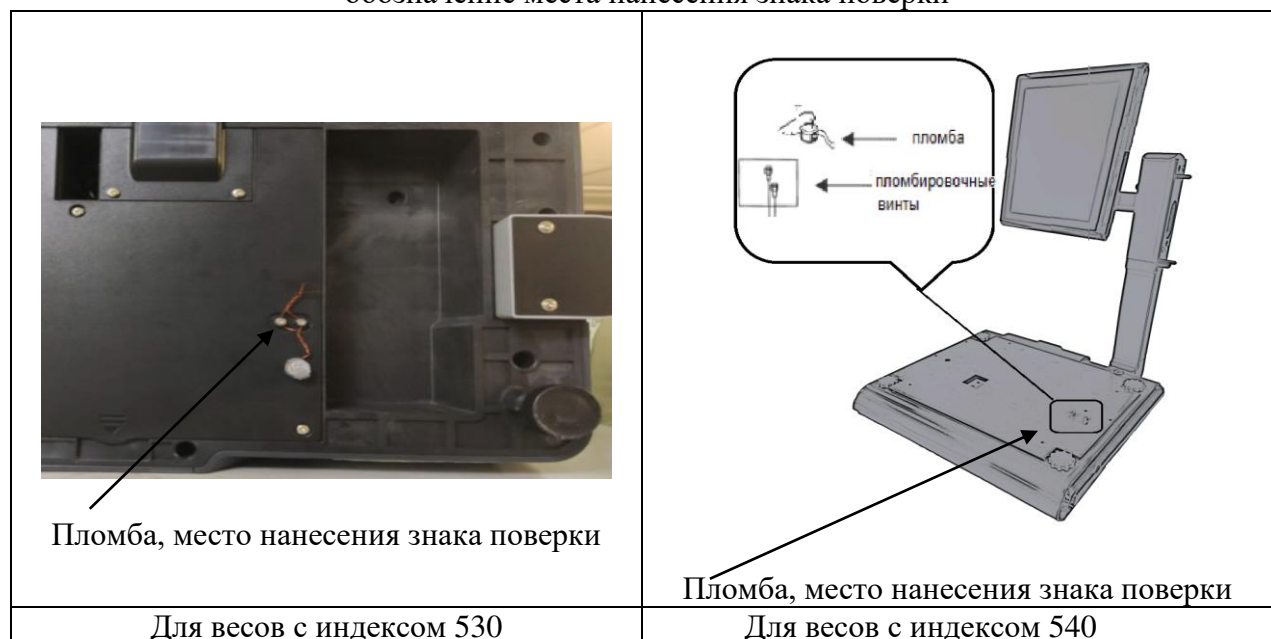
Рисунок 7 - Схемы пломбировки весов от несанкционированного доступа, обозначение места нанесения знака поверки
