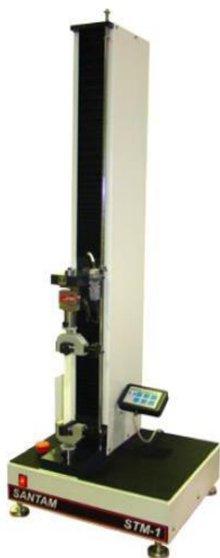
Рисунок 1 – Общий вид машин модификации STM-1
