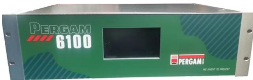
Рисунок 1 – Общий вид газоанализаторов PERGAM 6100 исполнение 1 и исполнение 2. Передняя панель
