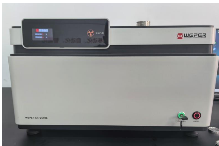
Рисунок 4 – Общий вид спектрометра рентгеновского энергодисперсионного WEPER модели XRF2500E
