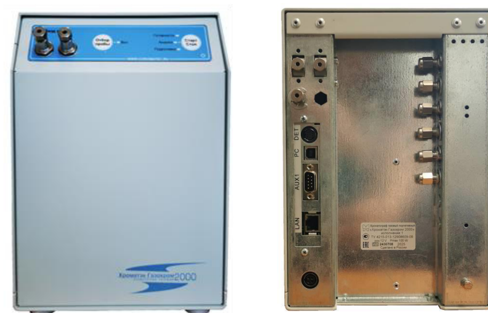
Рисунок 1 – Общий вид хроматографа исполнения 1
