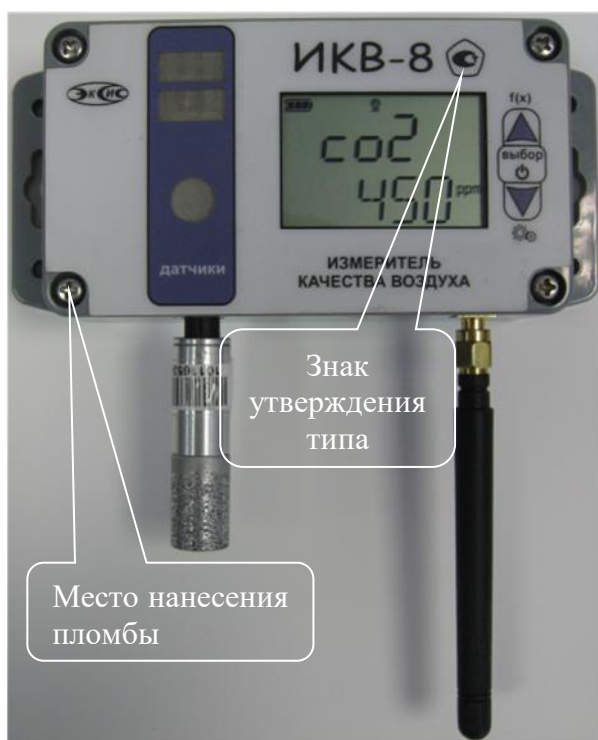
в) ИКВ-8-Н, изготовитель АО «ЭКСИС»
