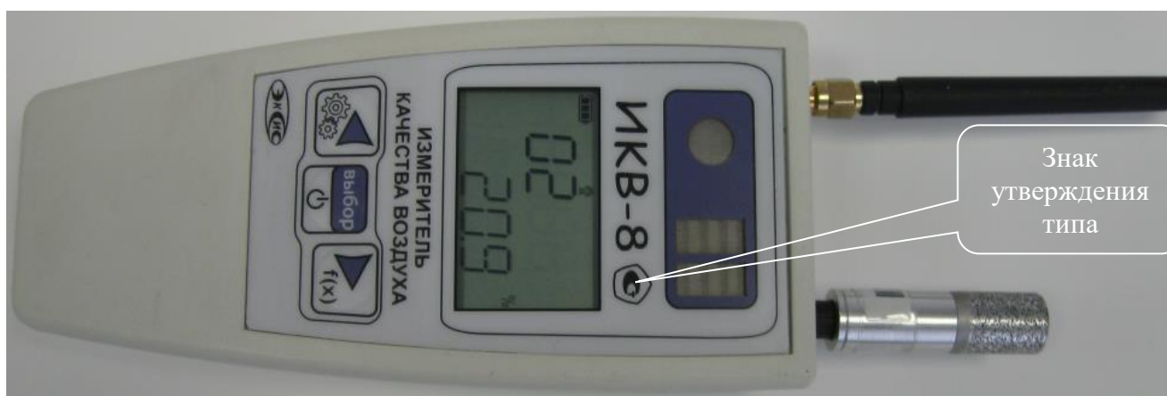
а) ИКВ-8-П, изготовитель АО «ЭКСИС»
