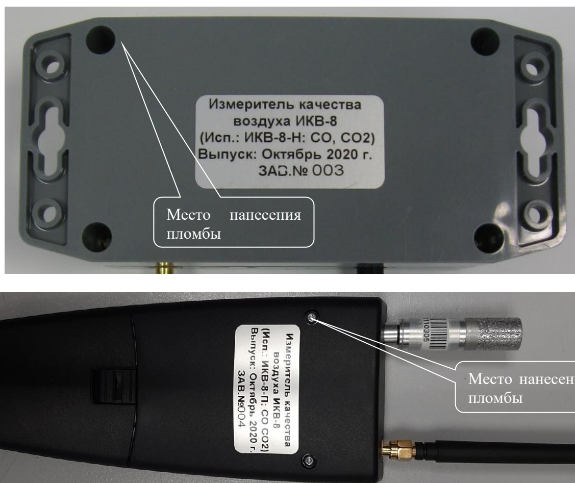
Рисунок 2 – Общий вид таблички с маркировкой измерителей и схема пломбирования от несанкционированного доступа (место пломбирования)
