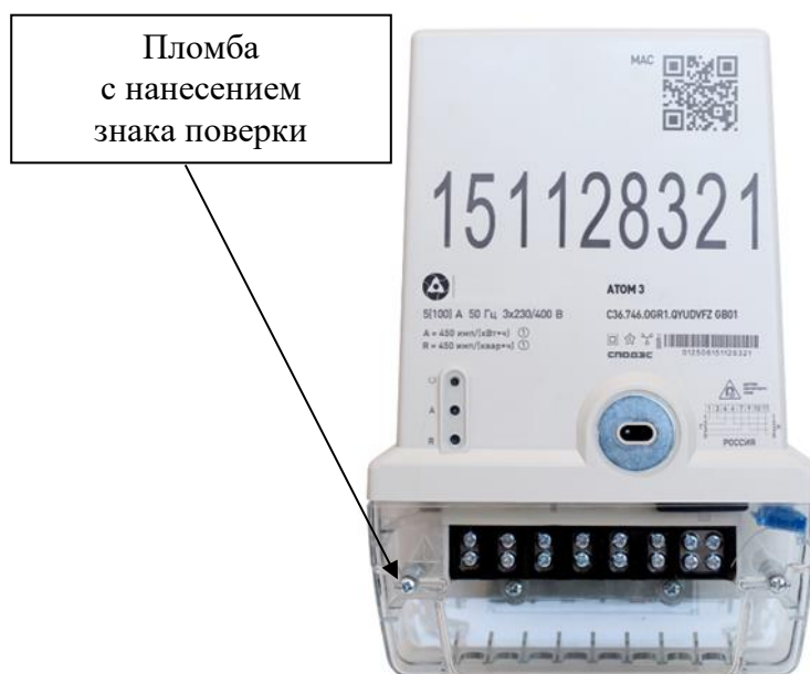
г) счетчик в исполнении корпуса с индексом С36 – для наружной установки
