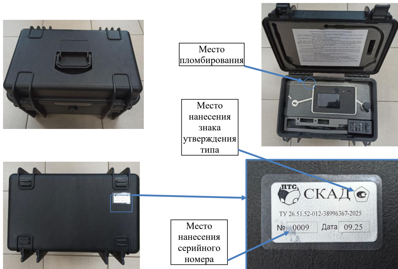
Рисунок 1 – Общий вид блоков с указанием места нанесения серийного номера, знака утверждения типа и места пломбирования
