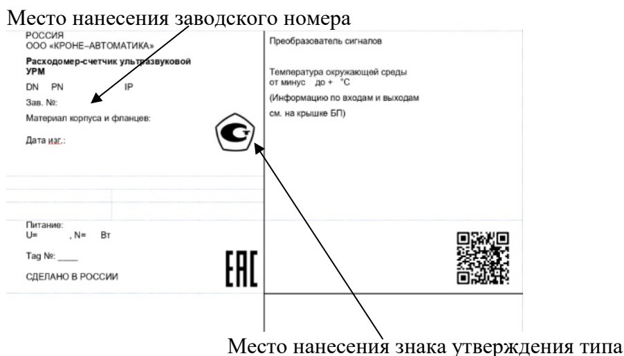
Рисунок 5 – Пример маркировочной таблички компактной версии расходомера
