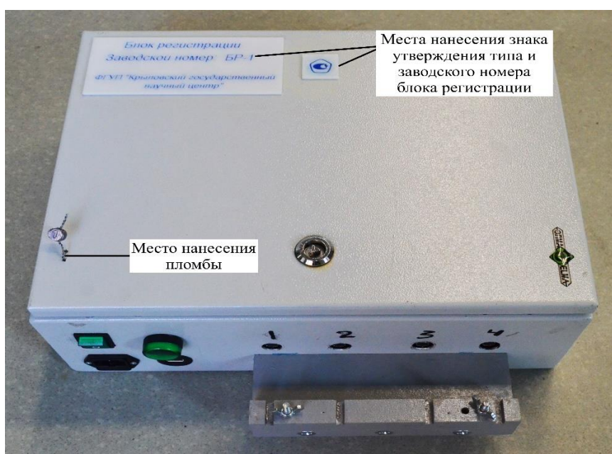
Рисунок 2 – Общий вид блока регистрации с указанием мест нанесения заводского номера, знака утверждения типа и схемы пломбировки от несанкционированного доступа
