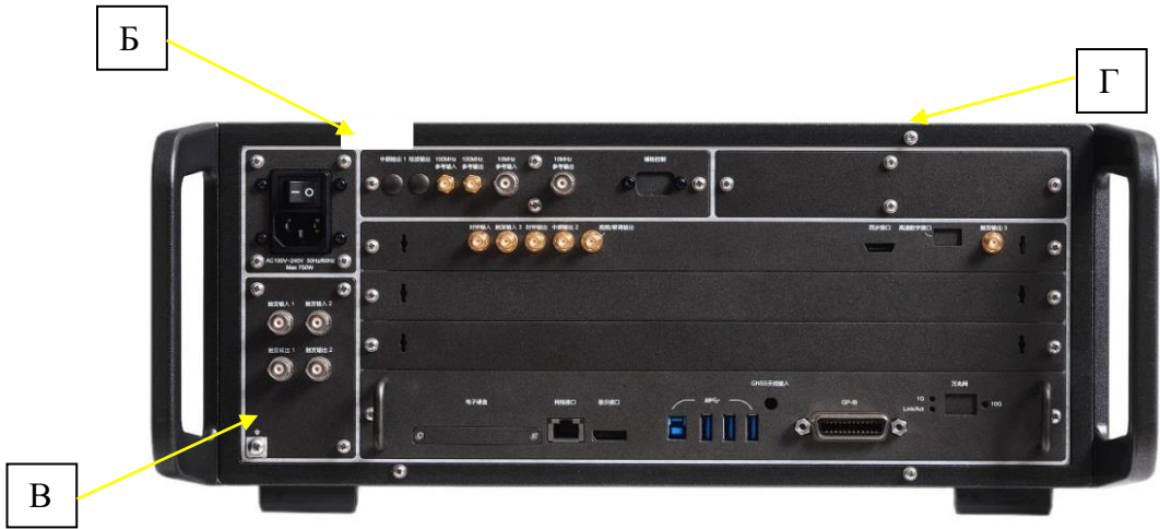
Рисунок 2 – Схема пломбировки от несанкционированного доступа (Б), место нанесения серийного номера (В) и знака поверки (Г)
