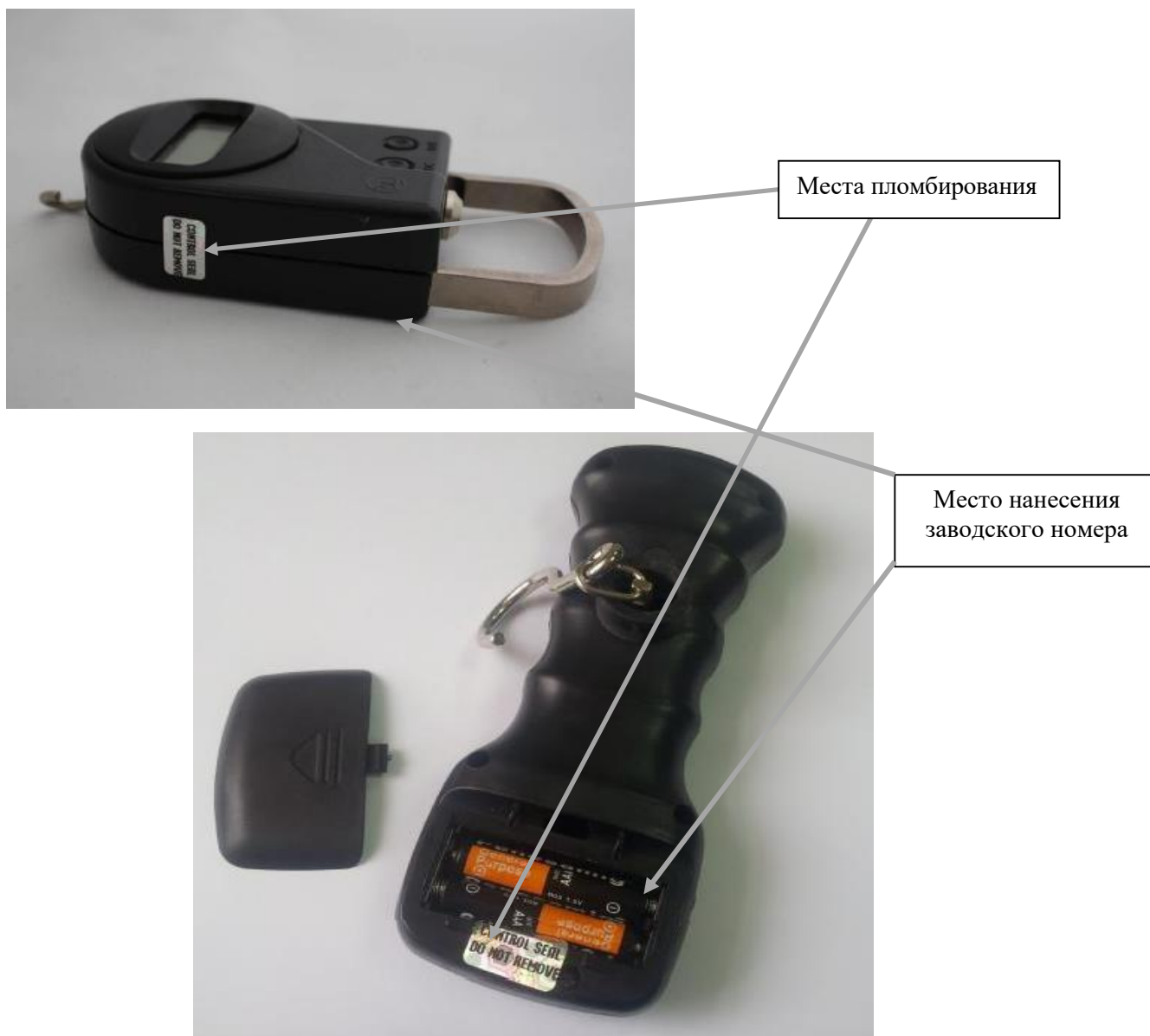
Рисунок 3 - Схема пломбирования электронного блока от несанкционированного доступа и место нанесения заводского номера
