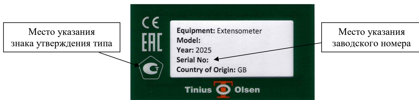
Рисунок 2 – Общий вид маркировочной таблички с местом указания заводского номера и знака утверждения типа
