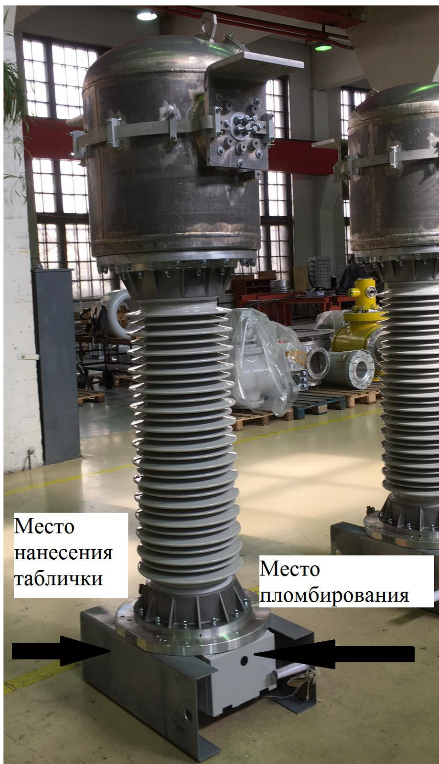
Рисунок 1 – Внешний вид ТГФМ-110, место нанесения заводского номера и место пломбирования
