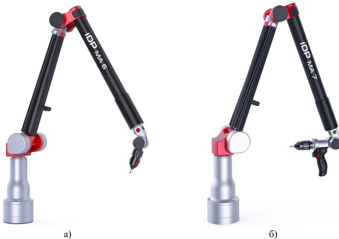
Рисунок 2 – Общий вид КИМ: а) модификаций Р, РХ и В с шестью осями вращения; б) модификаций Р и РХ с семью осями вращения
