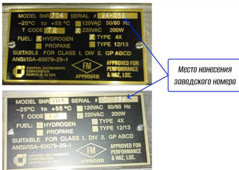
Рисунок 2 – Идентификационные таблички газоанализаторов с указанием места нанесения заводского номера
