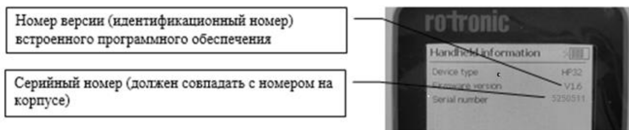
Рисунок 3 – Отображение серийного номера и версии встроенного программного обеспечения на дисплее. Для вывода меню отображения серийного номера - 3 раза нажать клавишу «ОК»
