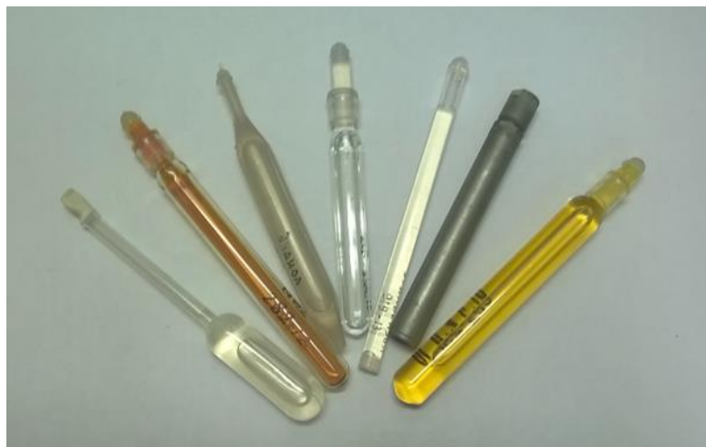
Рисунок 1 – Общий вид источников микропотоков газов и паров ИМ различных конструктивных исполнений
