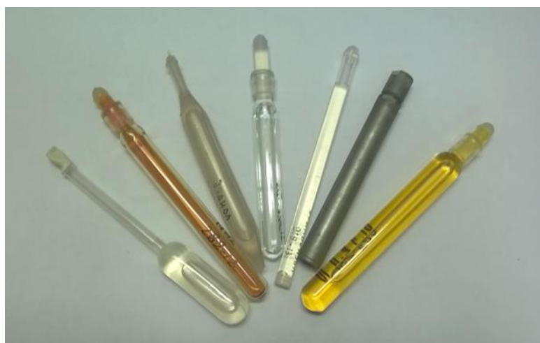
Рисунок 1 –Общий вид источников микропотоков газов и паров ИМ-0 различных конструктивных исполнений
