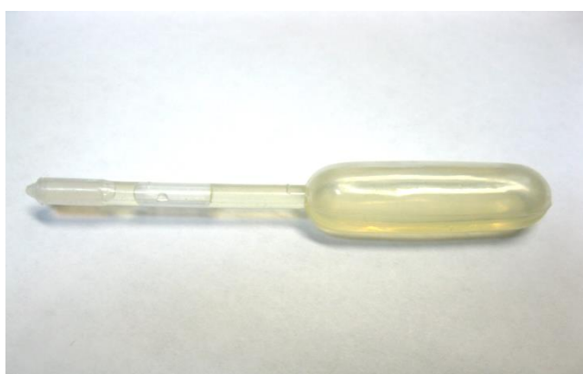
Рисунок 2 – Внешний вид источников микропотоков ИМ-ВРЗ, конструктивное исполнение И
