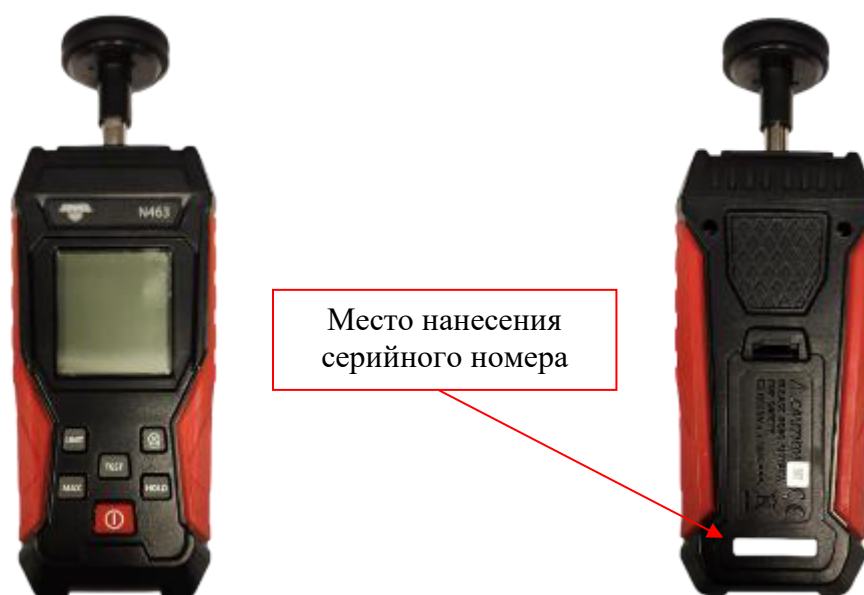
Рисунок 4 – Общий вид тахометров модификации АМО N463 с указанием места нанесения знака утверждения типа и места нанесения серийного номера
