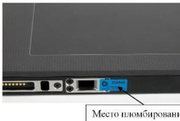
Рисунок 7 – Место установки пломбы от несанкционированного доступа
