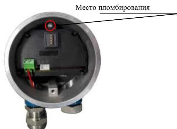
Рисунок 3 – Место нанесения защитной пломбы
