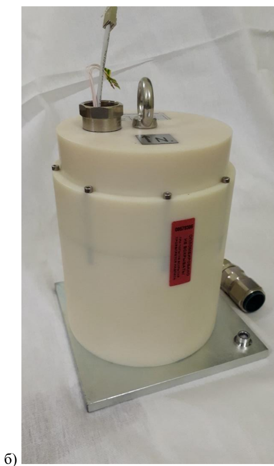
Рисунок 1 – Общий вид станции сейсмической Апатит: а) – модификация Апатит-АН б) – модификации Апатит-OBS
