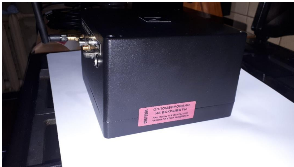
Рисунок 2 – Схема пломбировки станции Апатит от несанкционированного доступа
