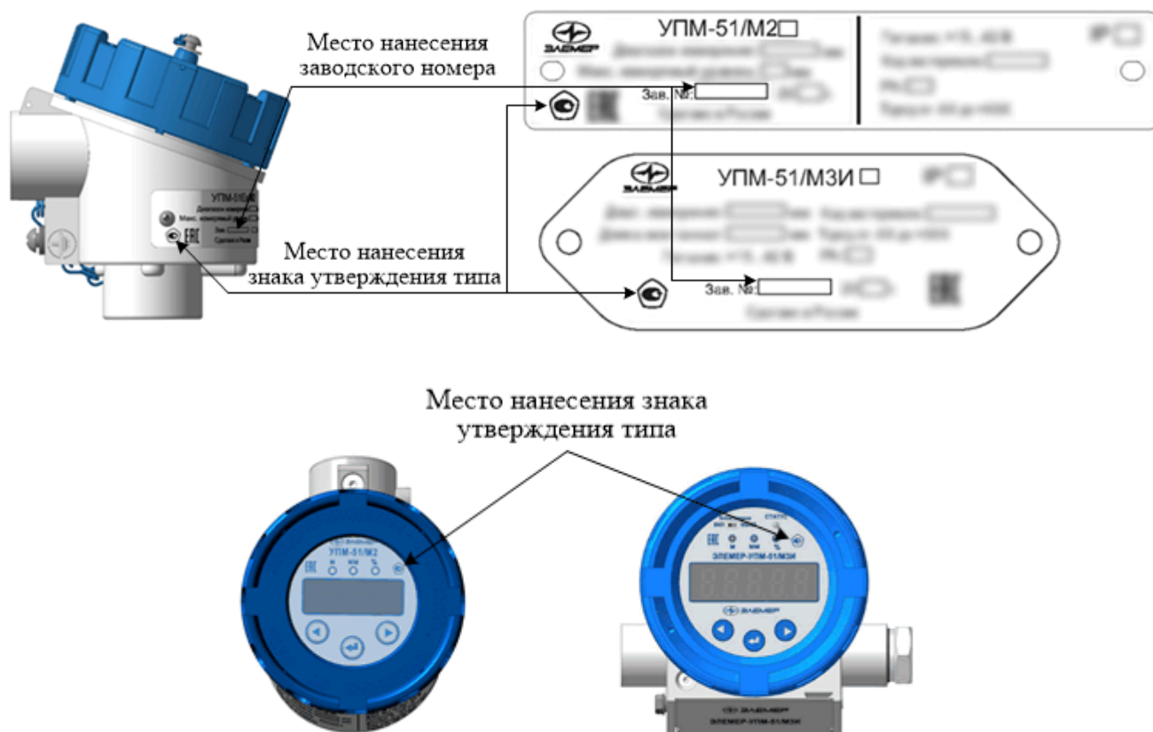
Рисунок 7 – Место нанесения заводского номера и знака утверждения типа
