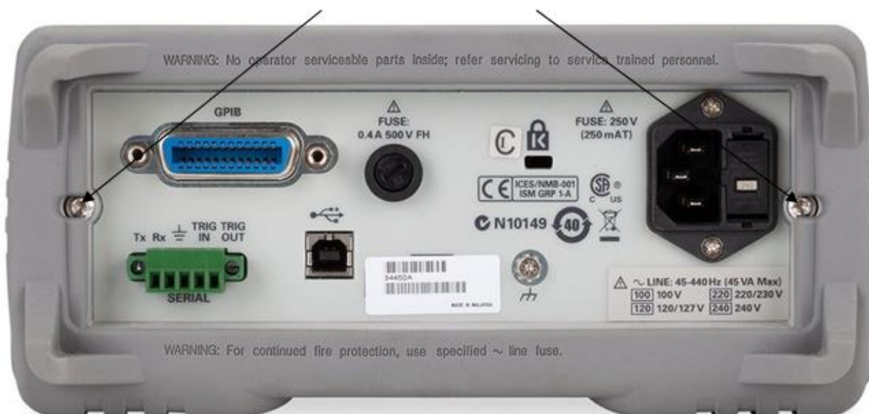
Рисунок 2 – Схема пломбирования от несанкционированного доступа
