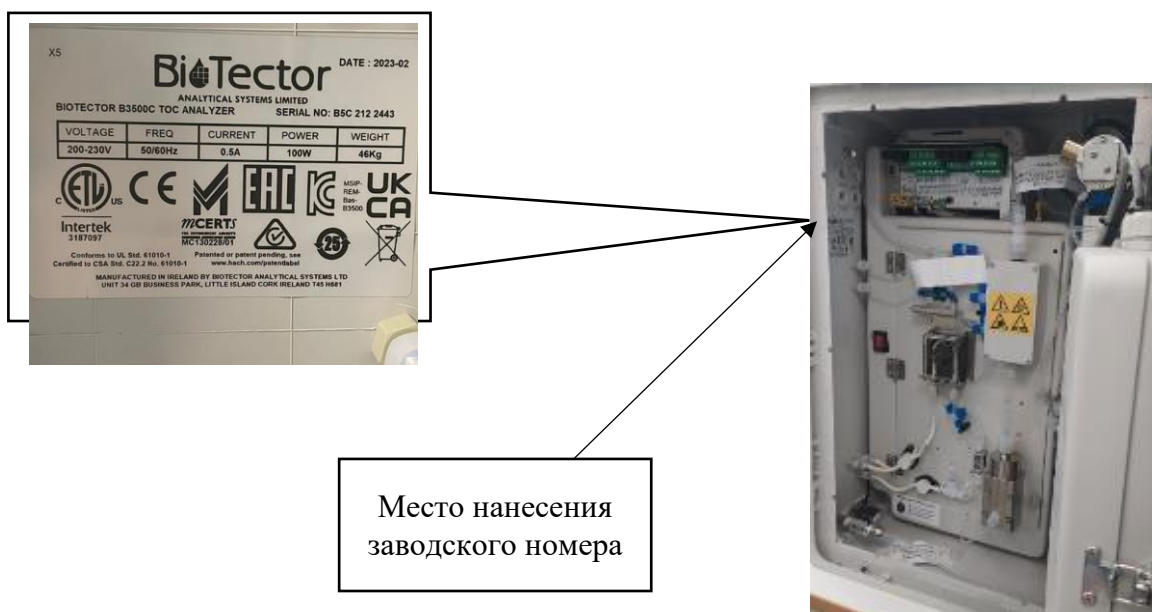
Рисунок 1 – Общий вид анализаторов общего органического углерода BIOTECTOR B3500C TOC с указанием места нанесения знака утверждения типа и места пломбировки от несанкционированного доступа
