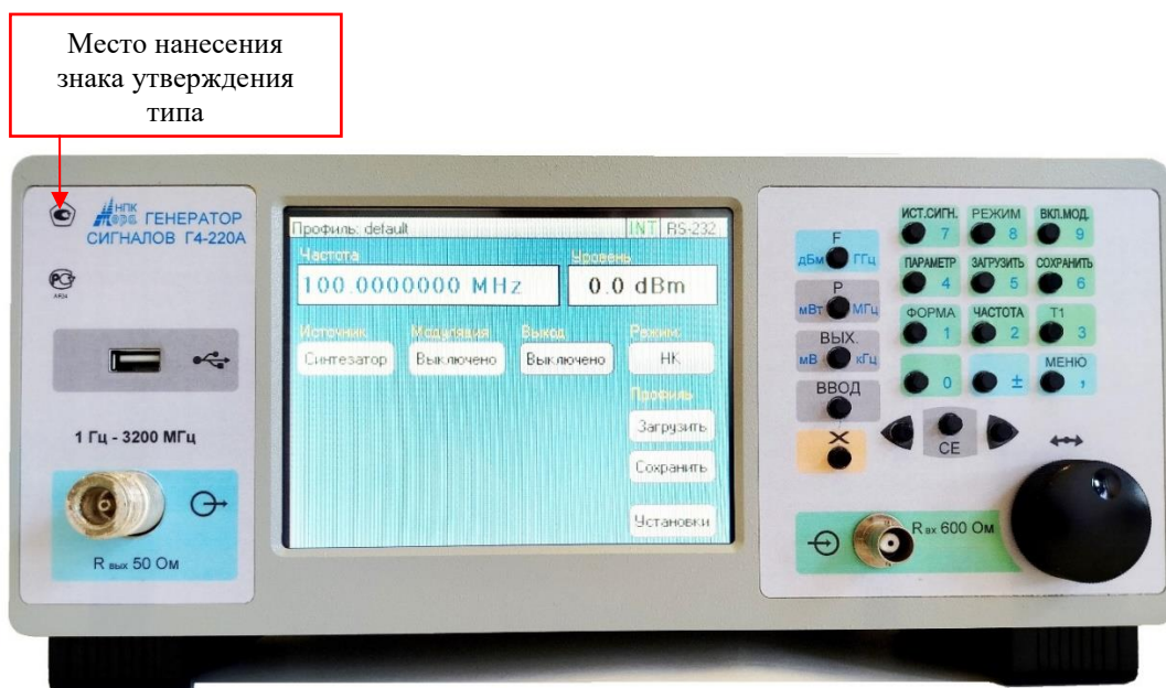
Рисунок 4 – Фотография общего вида генератора Г4-220А, выпускаемого в металлическом корпусе, с указанием места нанесения знака утверждения типа
