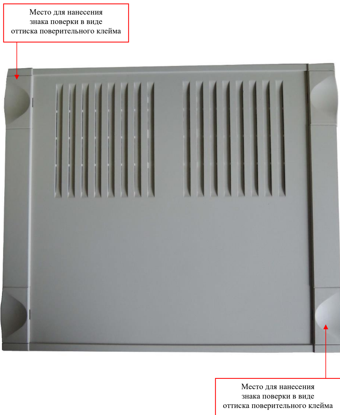
Рисунок 3 – Фотография генератора Г4-220А, выпускаемого в пластмассовом корпусе, с указанием мест нанесения знака поверки в виде оттиска поверительного клейма, нанесенного на мастичные пломбы
