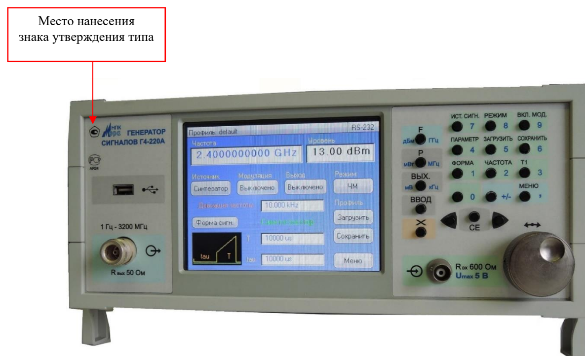
Рисунок 1 – Фотография общего вида генератора Г4-220А, выпускаемого в пластмассовом корпусе, с указанием места нанесения знака утверждения типа
