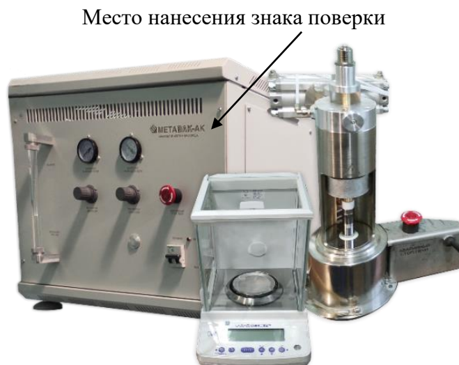
Рисунок 2 – Общий вид анализаторов газов в твердых материалах моделей МЕТАВАК-АК, МЕТАВАК-А, МЕТАВАК-АВ, МЕТАВАК-К, МЕТАВАК-ВК, МЕТАВАК-В, МЕТАВАК-ВАК при исполнении в виде отдельных блоков: блока импульсной печи и аналитического блока
