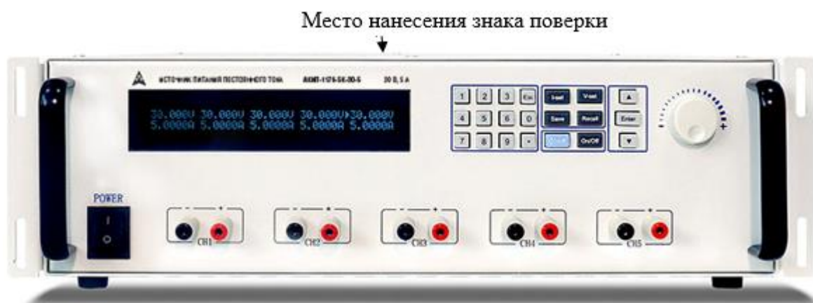
Рисунок 6 – Место нанесения знака поверки источников АКИП-1176-5К-30-3, АКИП-1176-5К-30-5, АКИП-1176-5К-60-3
