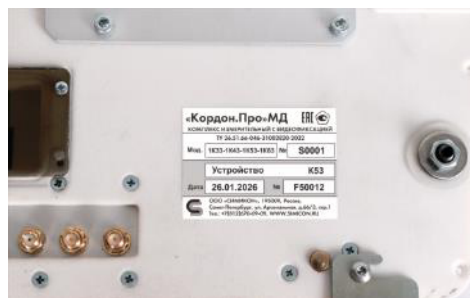
Место маркировки, нанесения знака утверждения типа и заводского номера
