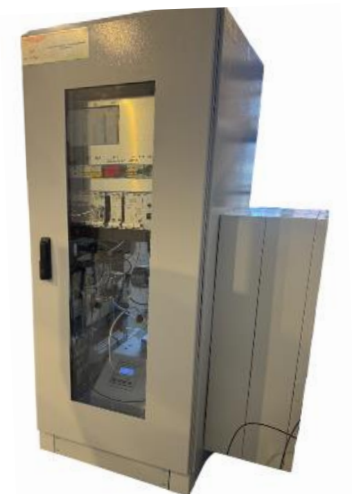
а) шкаф газоаналитический (временапролетный масс-анализатор)
