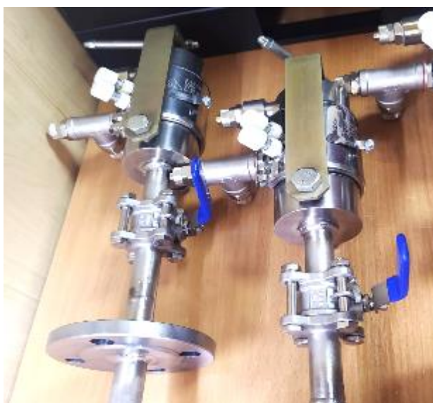
д) пробоотборное устройство с внешней фильтрацией и дополнительным обогревом фильтра
