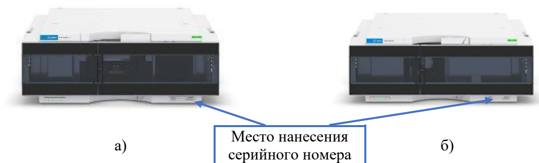
Рисунок 2 – Общий вид детекторов: а) DAD; б) FLD с указанием места нанесения серийного номера
